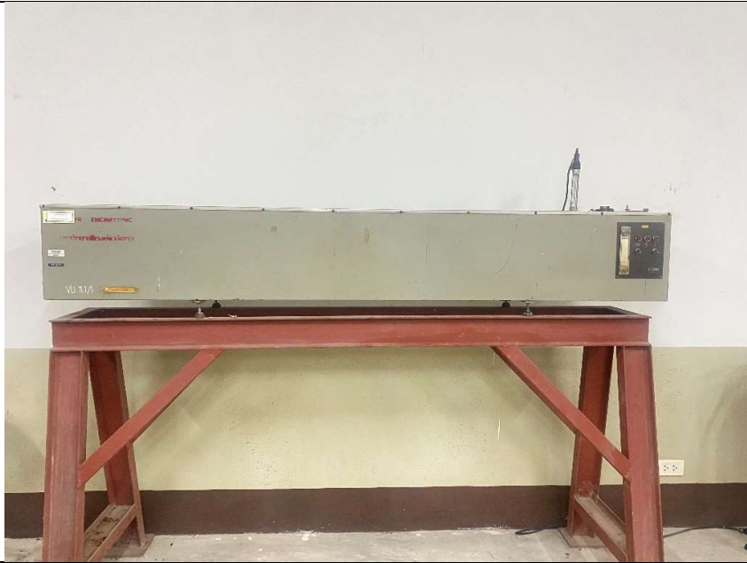
8. อุปกรณ์ทดสอบหาจุดวาบไฟ และจุดติดไฟ โดยใช้ Cleveland open cup
