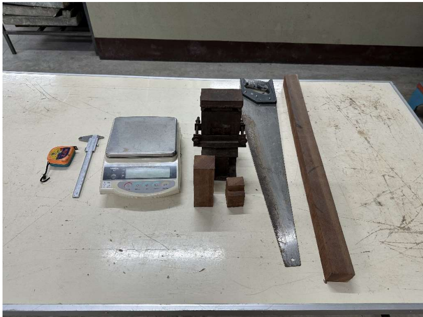
12. อุปกรณ์ทดลองกำลังรับแรงของไม้
