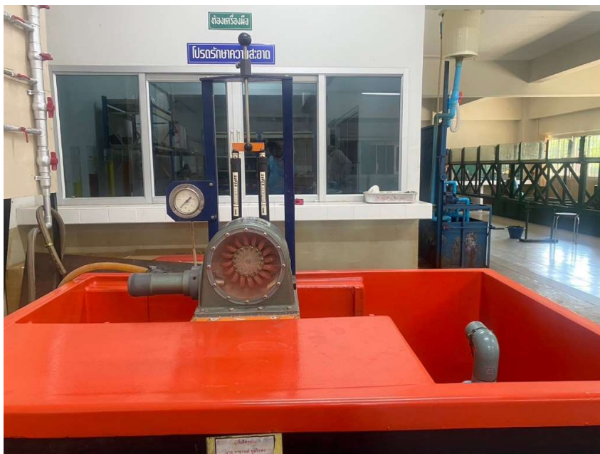
3. โต๊ะชลศาสตร์สำหรับการทดสอบการไหลผ่านฝายรูปแบบต่าง ๆ
