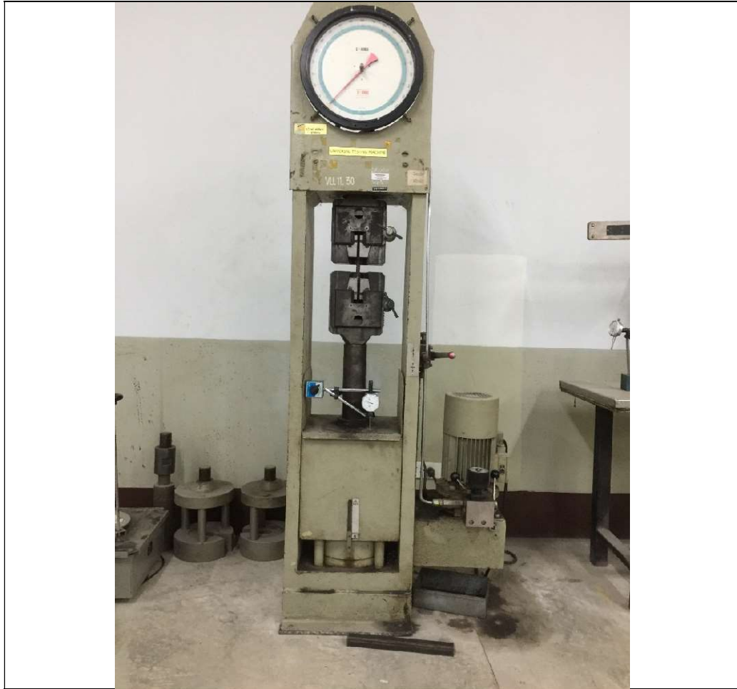
12. อุปกรณ์ทดลองกำลังรับแรงของไม้
