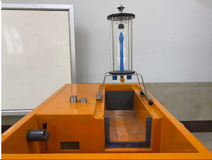
9. อุปกรณ์ทดลองแรงเสียดทานในท่อ
