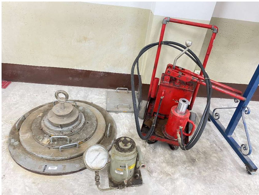
5. อุปกรณ์ทดลองแคลิฟอร์เนีย แบริงเรโซ (California Bearing Ratio)
