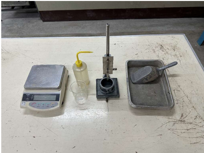
9. อุปกรณ์ทดลองการวิเคราะห์คอนกรีตสด
