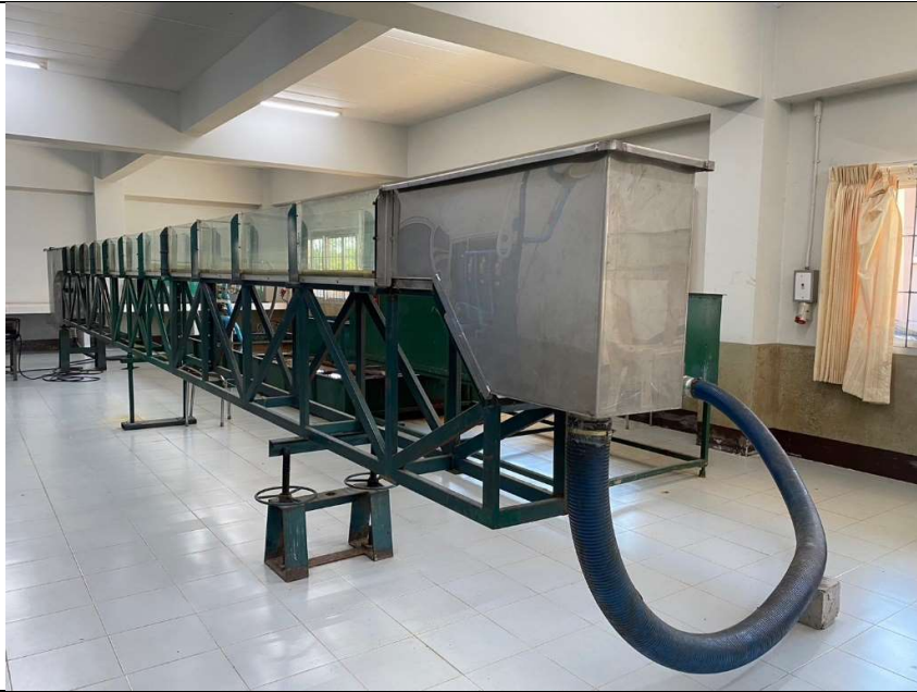
2. อุปกรณ์ทดลองคุณลักษณะของเฟลตั้นเทอร์ไบน์
