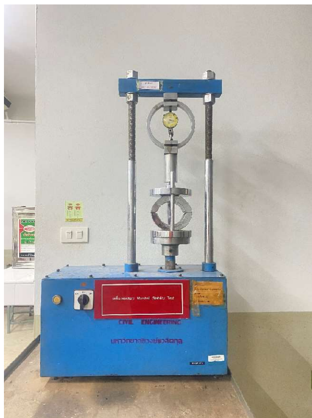
10. อุปกรณ์ทดลองแอสฟัลต์ติกคอนกรีตด้วยวิธี Marshall
