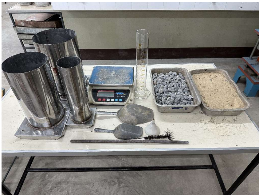
7. อุปกรณ์ทดสอบหาความถ่วงจำเพาะและความสามารถดูดซึมของมวลรวม
