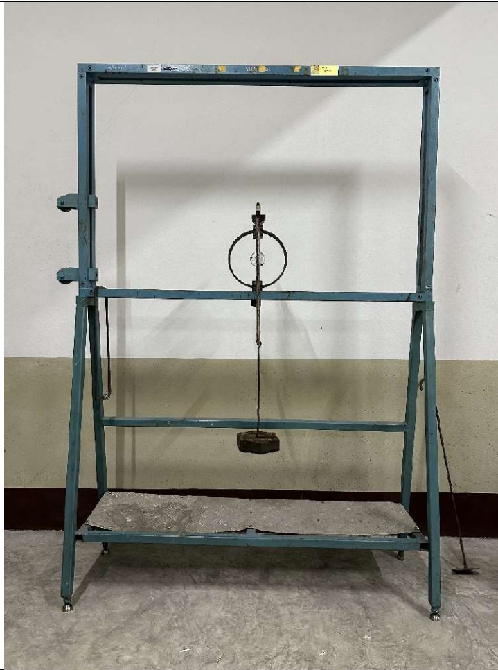
2. อุปกรณ์ทดสอบแรงดึงของวัสดุ
