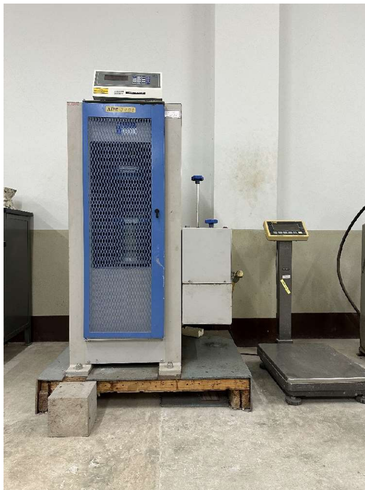
11. อุปกรณ์ทดสอบกำลังรับแรงดึงของเหล็กและอลูมิเนียม
