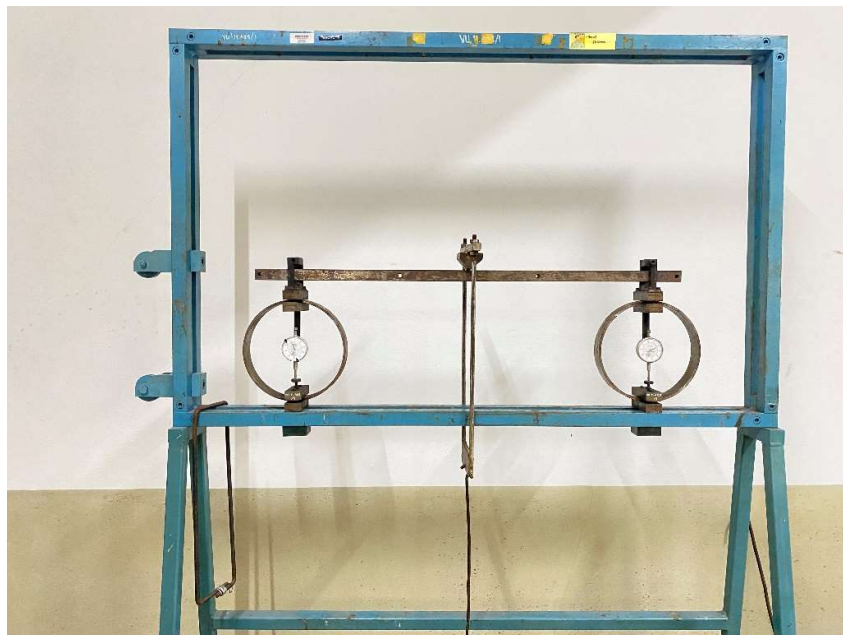
12. อุปกรณ์ทดลองการวิเคราะห์การเสียรูปของโครงข้อหมุน
