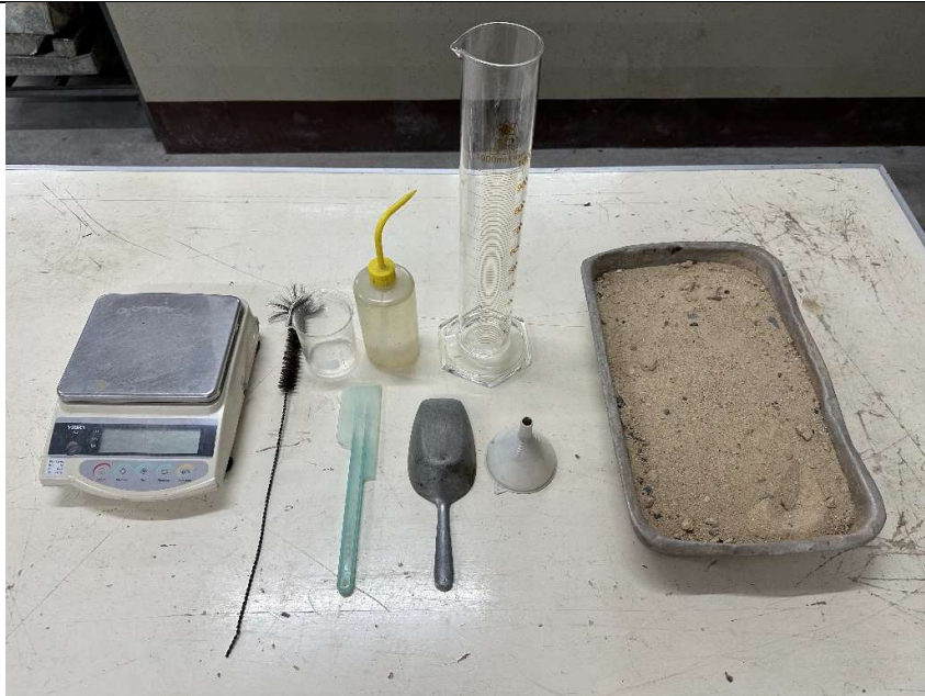
4. อุปกรณ์ทดลองวิเคราะห์ขนาดมวลรวมด้วยตะแกรง
