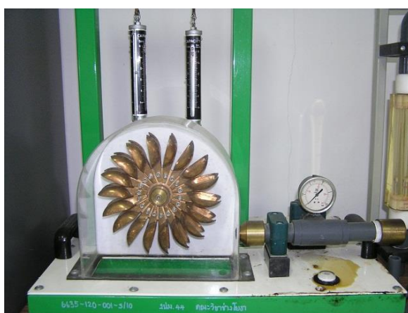
ชุดการทดสอบกังหันน้ำแบบเพลตัน
