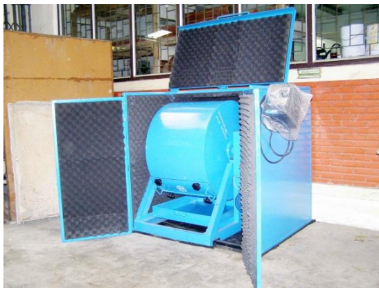
เครื่องมือหาความต้านทานการขัดสีของหิน (Los Angeles Abrasion)
