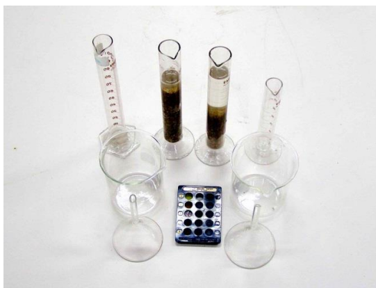
เครื่องทดสอบหาสารอินทรีย์ในทราย
