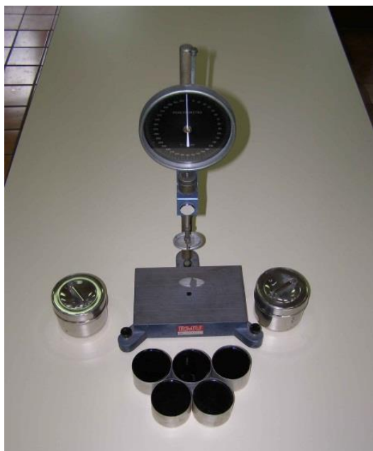
ชุดการทดสอบ Penetration ของวัสดุปิฐเมน
