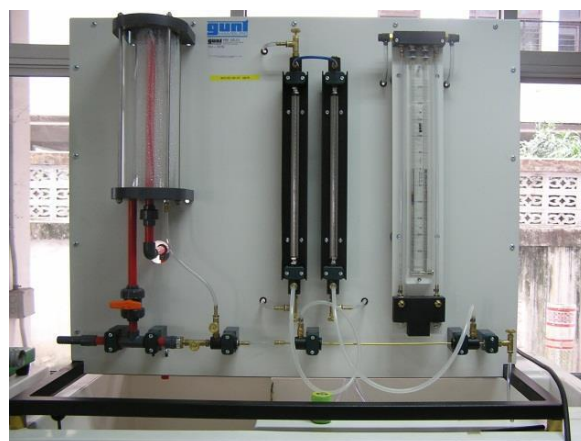
ชุดการทดลองการกระแทกของลำน้ำ
