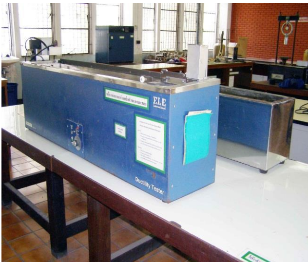
เครื่องทดสอบความยืดดึงของวัสดุพิวเมน
