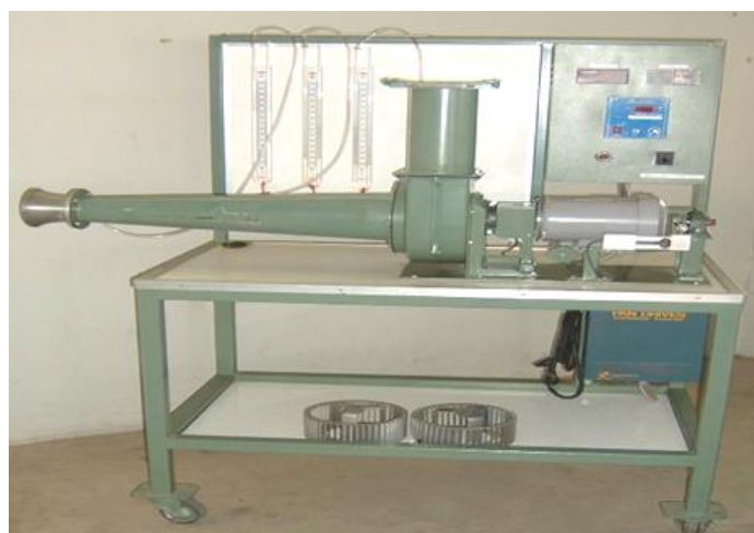
1.8.6 ชุดทดลองสมรรถนะพัดลม (Fan Tests)
