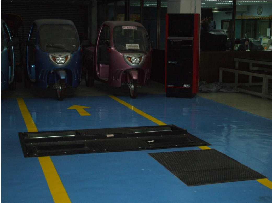
เครื่องทดสอบระบบเบรกและใช้คัพและการลื่นไถล
