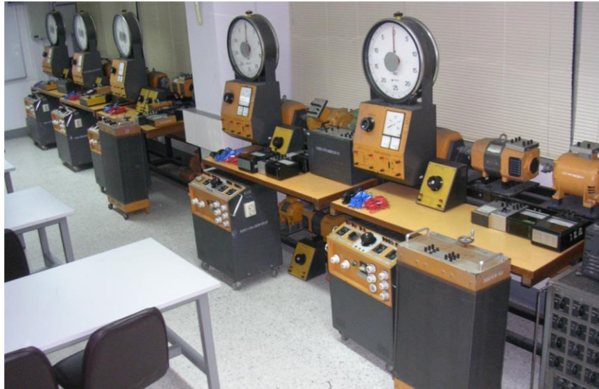
ชุดทดลองเครื่องจักรกลไฟฟ้า ขนาด 1000 วัตต์
