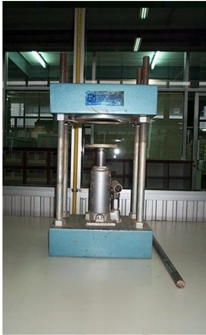
รูปที่ 10 เครื่องดันตัวอย่างดิน
