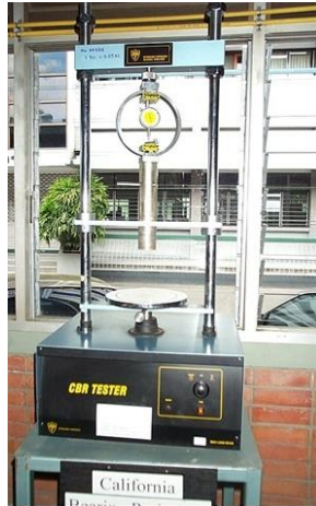
รูปที่ 19 California Bearing Ratio Test
