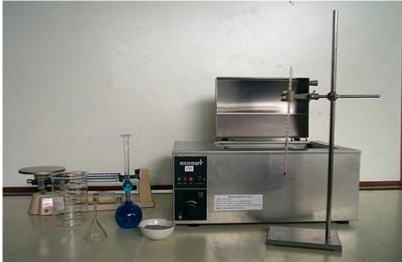
รูปที่ 1 การหาความถ่วงจำเพาะของปูนซีเมนต์
