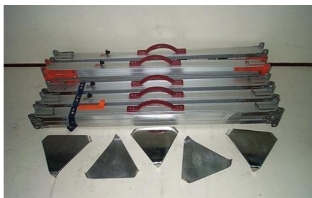
รูปที่ 5 ไม้ Staff พร้อม Foot Plate
