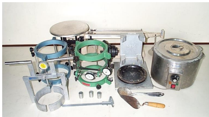
รูปที่ 28 การทดสอบกำลังอัดโมดูลัสยืดหยุ่นและอัตราส่วนปัวซอง
