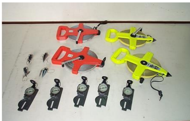
รูปที่ 14 เครื่องมือการทดสอบการสำรวจด้วยเข็มทิศ
