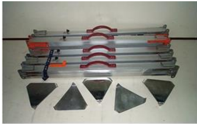
รูปที่ 7 ไม้ Staff พร้อม Foot Plate
