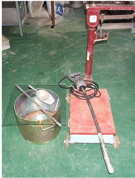
รูปที่ 26 การทดสอบหน่วยน้ำหนักและปริมาณอากาศ(Gravimetric)ของคอนกรีตสด
