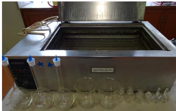
รูปที่ 1 เครื่องมือการทดสอบ ถพ. โดยขวด ถพ
