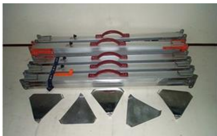
รูปที่ 23 ไม้ Staff พร้อม Foot Plate
