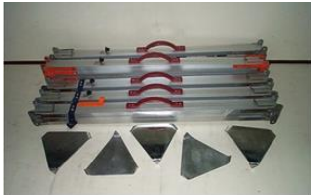
รูปที่ 9 ไม้ Staff พร้อม Foot Plate
