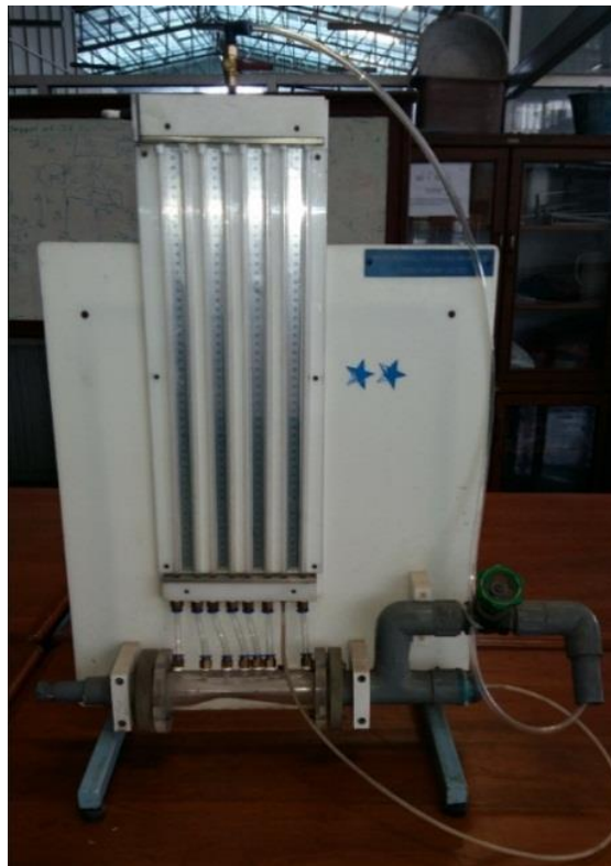
รูปที่ 6 ชุดการทดลองทฤษฎีของเบอร์นูลลี
