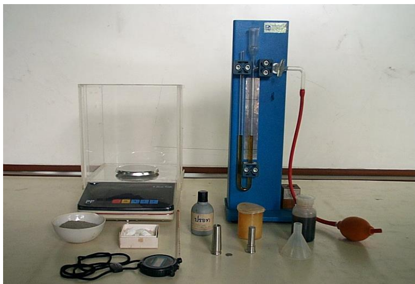
รูปที่ 2 การหาความละเอียดของปูนซีเมนต์ปอร์ตแลนด์โดยวิธีการซึมผ่านของอากาศ
