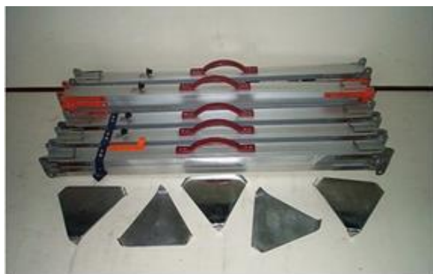
รูปที่ 11 ไม้ Staff พร้อม Foot Plate
