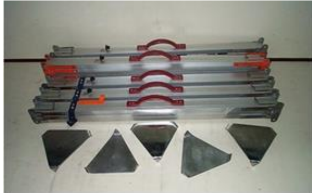
รูปที่ 13 ไม้ Staff พร้อม Foot Plate
