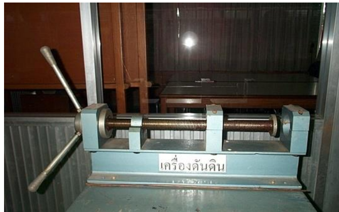
รูปที่ 12 เครื่องดันดิน
