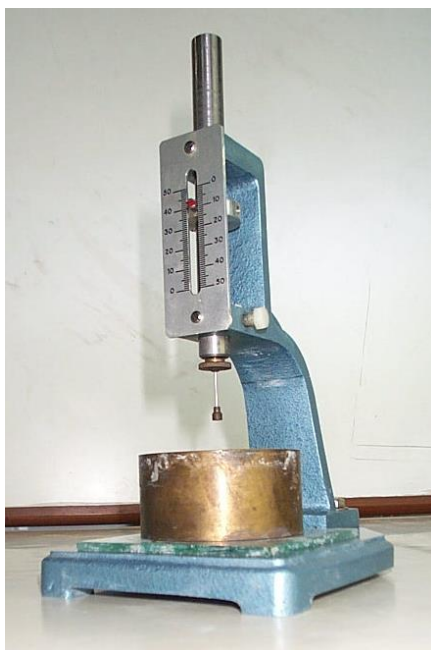
รูปที่ 15 การทดสอบหาระยะเวลาก่อตัวโดยเข็มไวแคท
