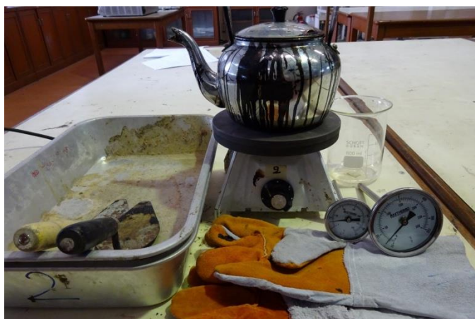
รูปที่ 15 เครื่องมือการทดสอบหินผสมกับยางมะตอย
