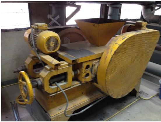
15. เครื่องบด Roll Crusher
