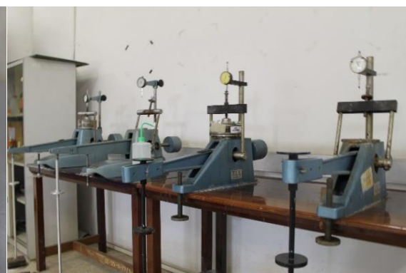
12. ชุดทดสอบ Consolidation Test
