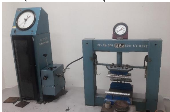
10. ชุดทดสอบกำลังอัดและดัดของคอนกรีต
