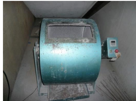
5. ชุดทดสอบการสึกหรอของวัสดุมวลรวม
