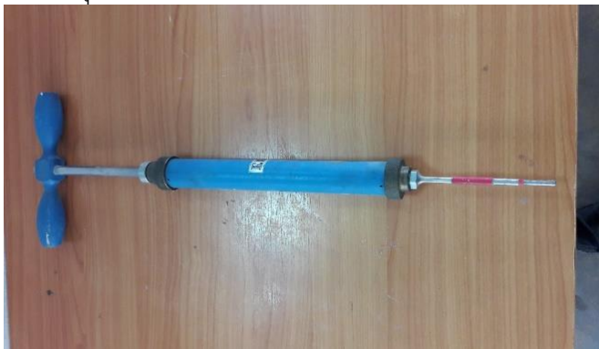
9. ชุดทดสอบเวลาการก่อตัวของคอนกรีต
