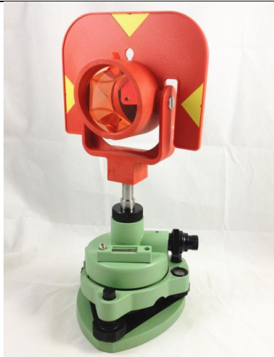
3. เป้าวัดมุม ยี่ห้อ LEICA รุ่น GPR 111
