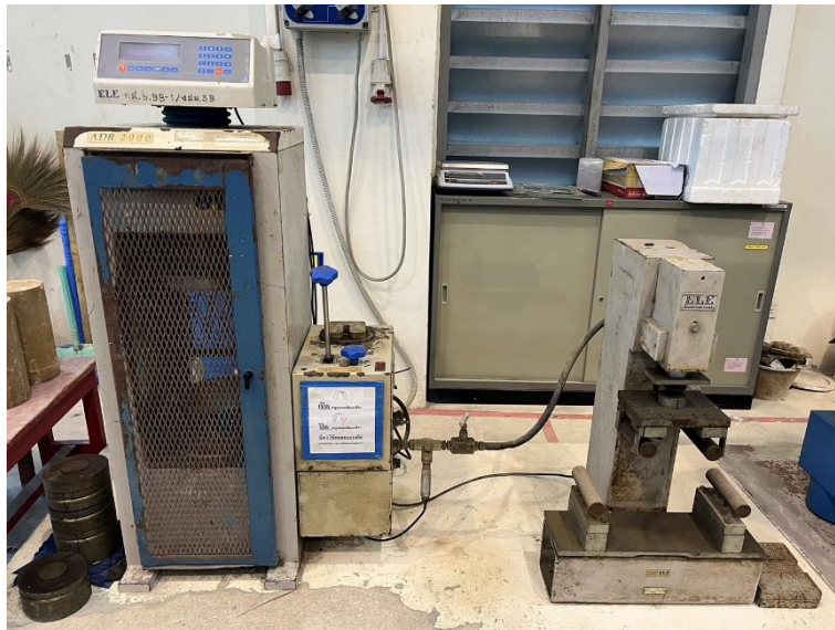
รูปที่ 5.30 ชุดทดสอบแรงกดและแรงดึง ขนาด 2000KN
