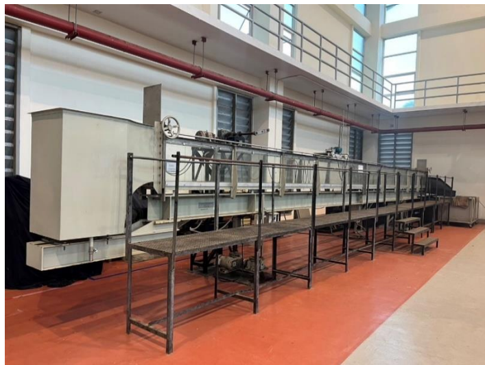
รูปที่ 5.22 ชุดทดสอบการไหลในรางน้ำเปิด ขนาด เมตร 5.12
