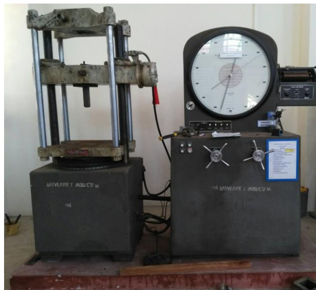
รูปที่ 5.29 ชุดทดสอบ Universal Testing Machine ขนาด 600 KN
