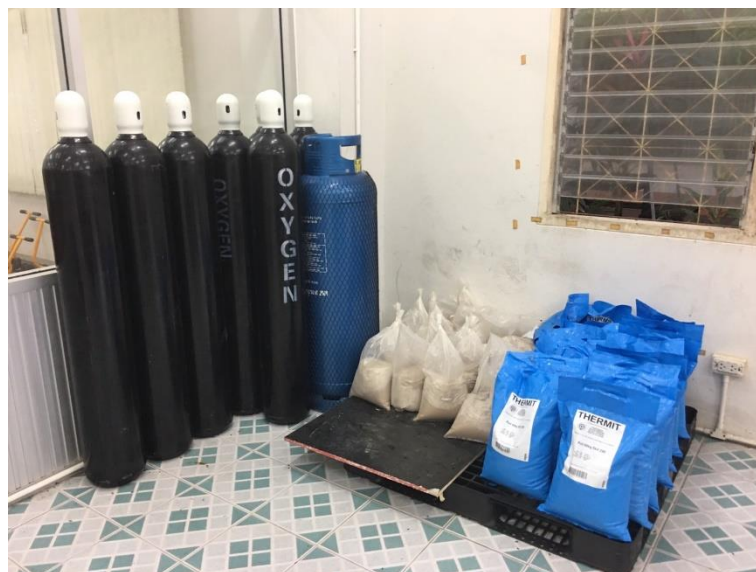
รูปที่ 5.117 ชุดฝึกปฏิบัติการเชื่อมรางรถไฟ UICด้วยเทอร์มิต 54
