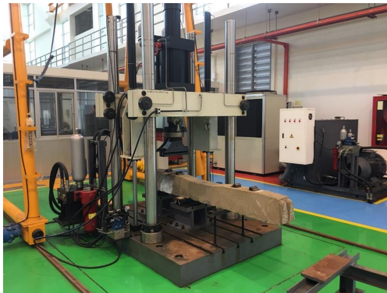
รูปที่ 5.104 ชุดปฏิบัติการทดสอบการต้านทานการรับน้ำหนักแบบคงที่และแบบพลศาสตร์ของรางรถไฟ
