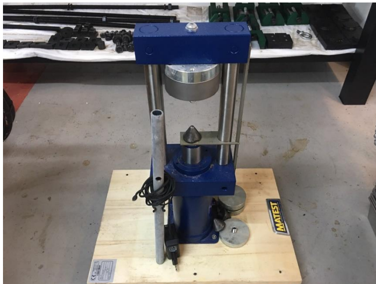
รูปที่ 5.116 ชุดทดสอบดัชนีความแข็งแรงจากน้ำหนักรีดแบบเป็นจุดของหินโรยทางรถไฟ
