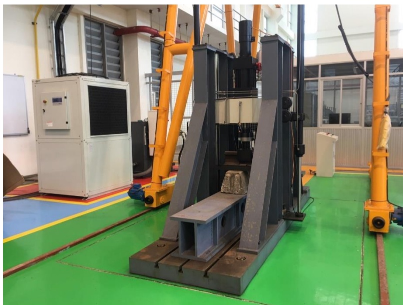
รูปที่ 5.105 ชุดปฏิบัติการทดสอบหาค่าความแข็งแรงของอุปกรณ์ยึดเกาะรางรถไฟโดยวิธีการให้แรง กระทำแบบพลศาสตร์
