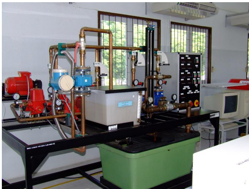
รูปที่ 5.26 ชุดทดสอบความสามารถของปั๊มแบบอนุกรมและขนาน
