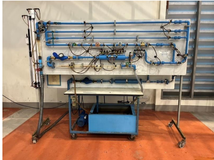
รูปที่ 5. 19 ชุดทดสอบการวัดอัตราการไหล และแรงเสียดทานในท่อปิด
