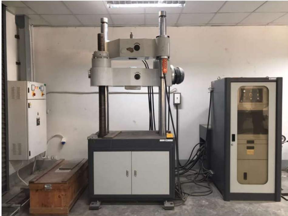
1. เครื่องทดสอบ Universal Testing Machine ขนาด 100 ตัน
