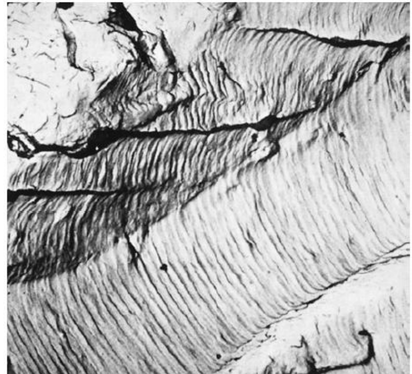
รูปที่ 16 ลักษณะการรับแรงของวัสดุที่ทำให้เกิดความล้า
