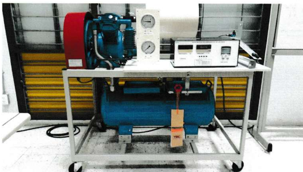
19.ชุดทดลองเครื่องอัดอากาศแบบ2ระดับ (TWO STAGE AIR COMPRESSOR TEST SET)
