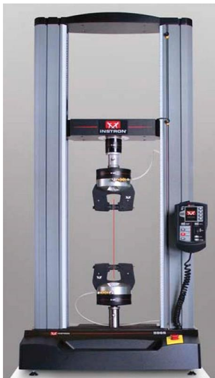
16. เครื่องทดสอบแรงดึง (Tensile strength tester) Instron: 5969
