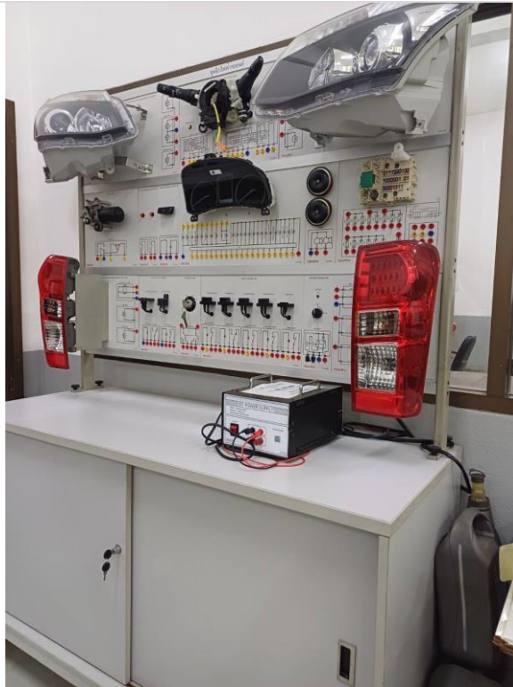
ชุดสายิตววงจรแผงไฟฟ้ารถยนต์ Isuzu d-max2015 (shop me. 103)
