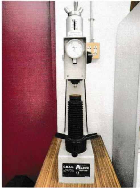
16. ชุดทดสอบความแข็ง (Hardness Tester) OMAG AFFRI 21056
