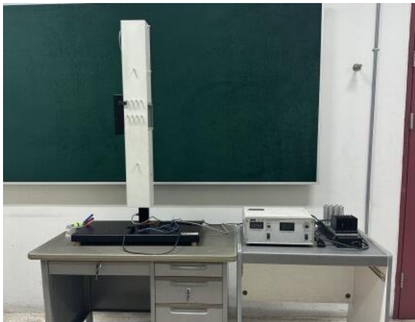
22. ชุดทดลองการพาความร้อนแบบอิสระและถูกบังคับ (Free and Forced Convection Study Unit)
