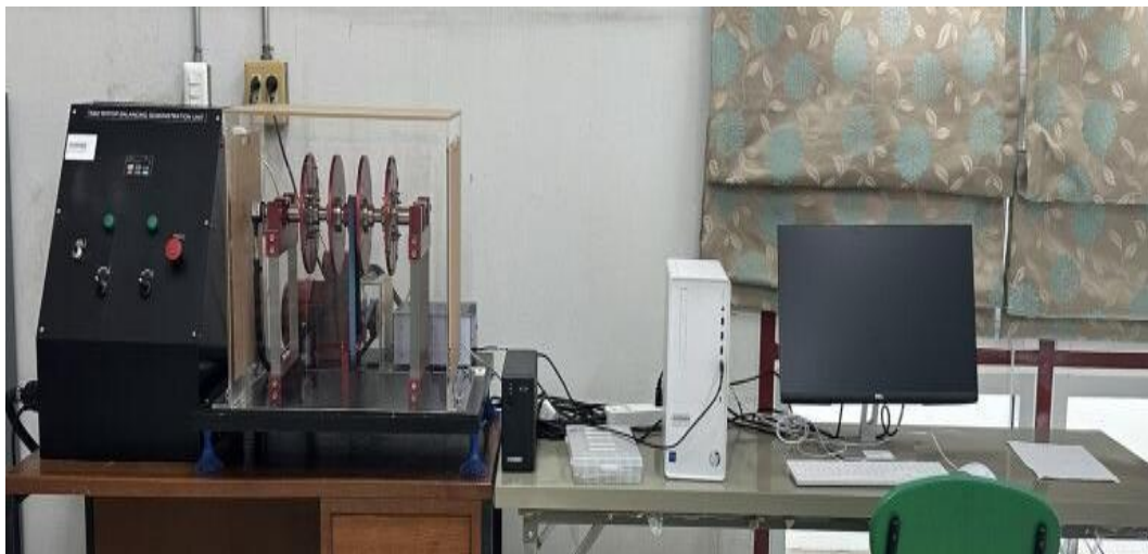
13. ชุดสาธิตหลักการสร้างสมดุลโรเตอร์ (TM02 ROTOR BALANCING DEMONSTRATION UNIT)
