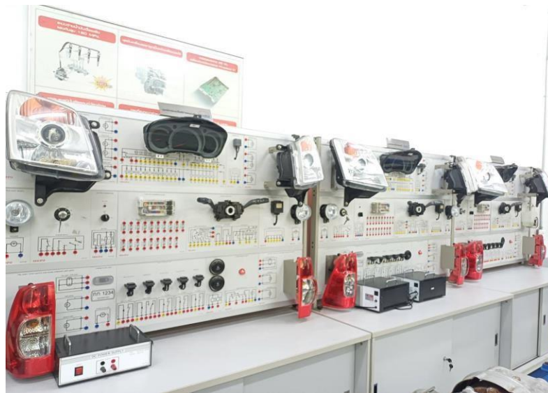
ชุดสายิตววงจรแผงไฟฟ้ารถยนต์ Isuzu d-max 2011 (shop me. 103)
