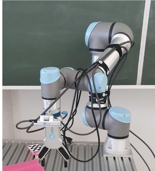
15.หุ่นยนต์แขนกลควบคุม6แกน (Position Control of 6 Axis Robot Arm) Universal Robots: UR5e
