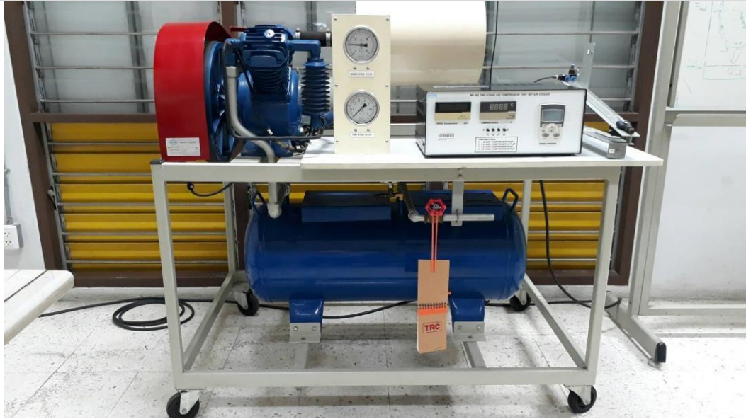
19. ชุดทดลองเครื่องอัดอากาศแบบ 2 ระดับ (TWO STAGE AIR COMPRESSOR TEST SET) ESSOM MP202 ห้อง 206 Floor 2 nd
