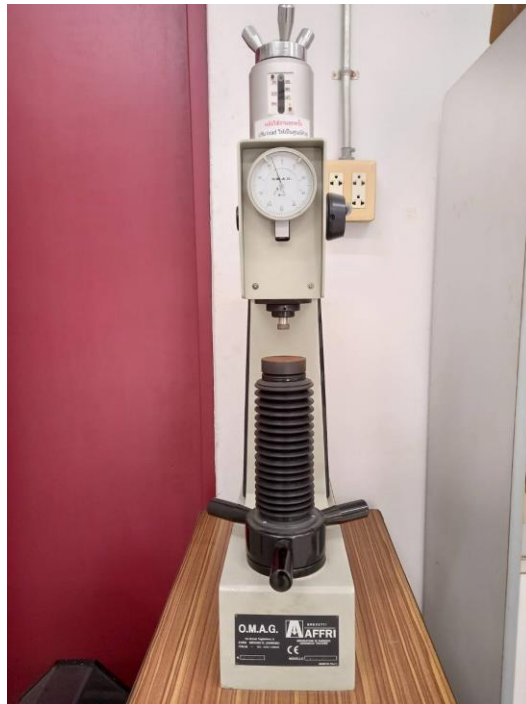
16. ชุดทดสอบความแข็งแรง (Hardness Tester) OMAG AFFRI 21056
