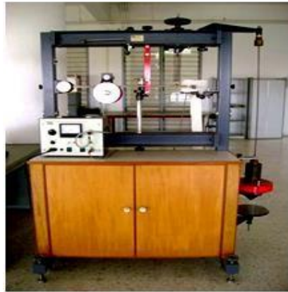
10. ชุดทดลองการสั่นสะเทือน (Free and Forced Vibration Test Set)
