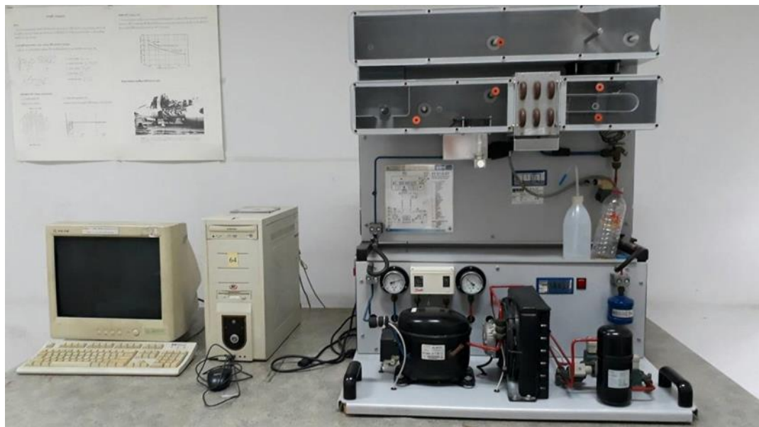
20. ชุดสาธิต วัฏจักรการทำความเย็น (Refrigeration Cycle Demonstration Unit) GUNT ET 915.07 ห้อง 206 Floor 2 nd
