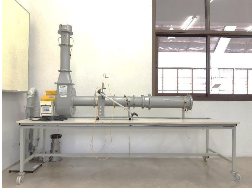
5. ชุดทดลองการวัดอัตราการไหลของอากาศ (Air Flow Bench) ESSOM MP -100
