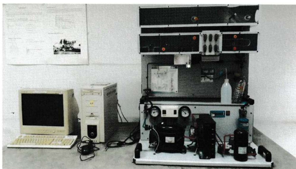
20.ชุดสาธิต วัฏจักรการทำความเย็น (Refrigeration Cycle Demonstration Unit)
