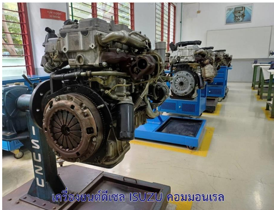
เครื่องยนต์ดีเซล 4สูบ Isuzu d-max คอมมอลเรล สำหรับรถประกอบ 5 เครื่อง (shop me. 103)
