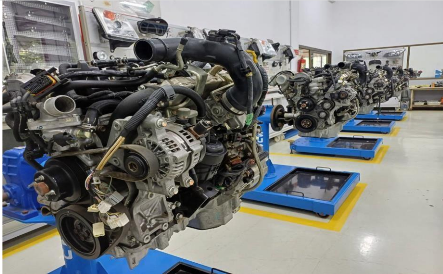
เครื่องยนต์ดีเซล 4สูบ isuzu d-max BLUE POWER คอมมอลเรล สำหรับรถประกอบ 5 เครื่อง (shop me. 103)
