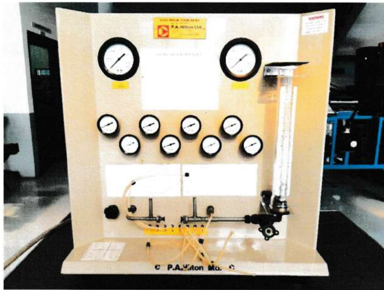
3.ชุดทดลองการไหลผ่านนอซเซิล (Nozzle Pressure Distribution Unit)
