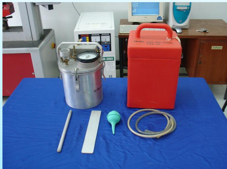
14. ชุดทดสอบการหาปริมาณอากาศในคอนกรีต
