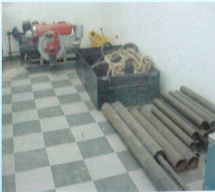
14.ชุดเครื่องมือเจาะสำรวจดินชนิด WASH BORING
