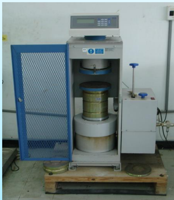
2. เครื่องทดสอบแรงกด (COMPRESSIVE TESTING MACHINE)
