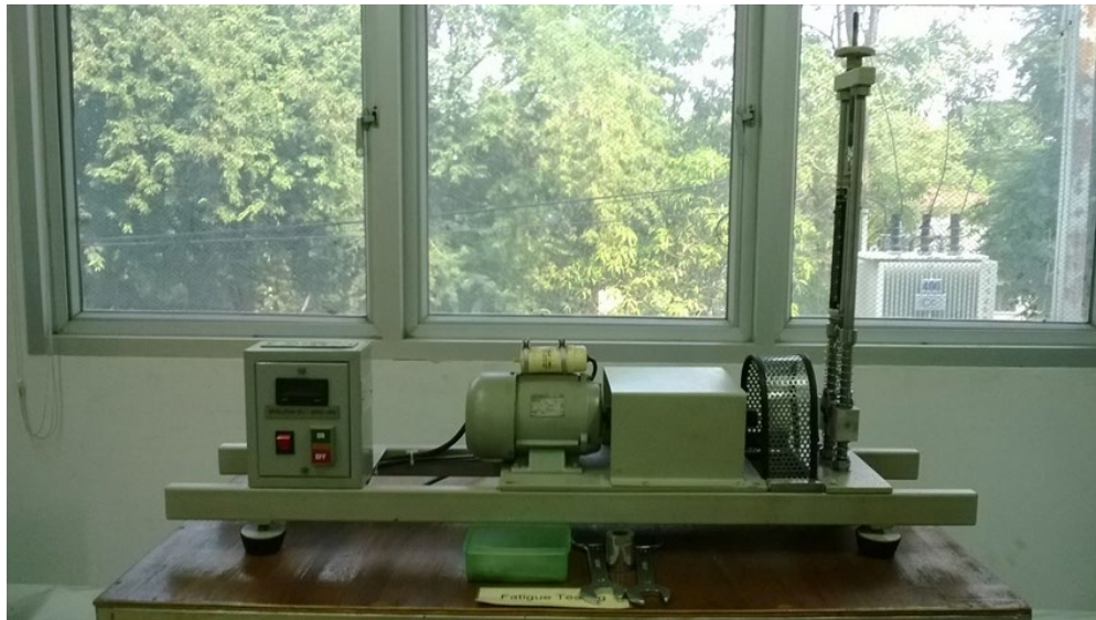
รูปที่ 1.4 Fatigue testing
