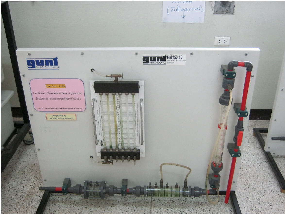
1.11) Orifice Venturi Flow meter test
