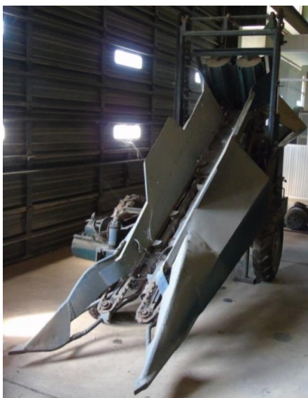
รูปที่ 64 เครื่องเก็บเกี่ยวข้าวโพดชนิดปลิดฝัก ข้าวโพด (corn snapper)
