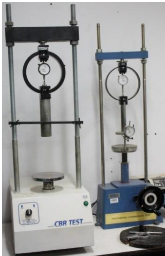
รูปที่ 131 เครื่องทดสอบ unconfined compression
