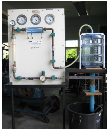
รูปที่ 93 ชุดการวัดอัตราการไหลของน้ำ (rotameter, manometer, venturimeter)
