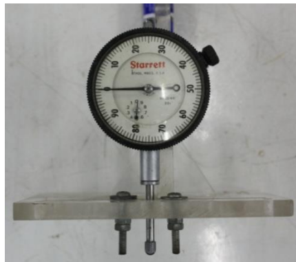
รูปที่ 47 Device for measuring radius of curve
