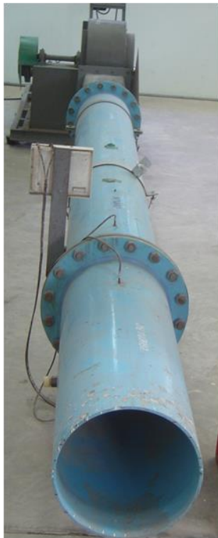
รูปที่ 76 ชุดทดสอบการสูญเสียพลังงานในท่อ
