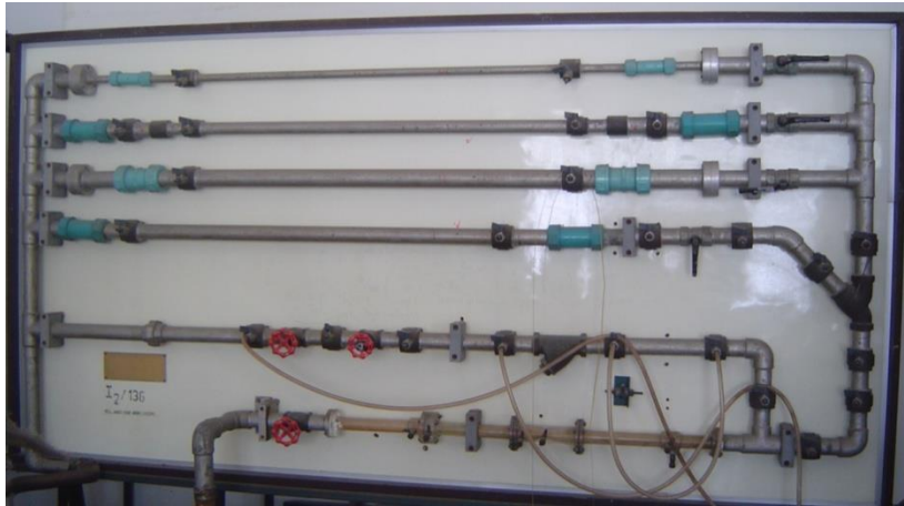
รูปที่ 76 ชุดทดสอบการสูญเสียพลังงานในท่อ
