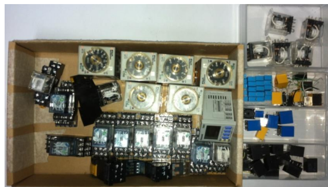
รูปที่ 17 magnetic contactor, relay และ timer
