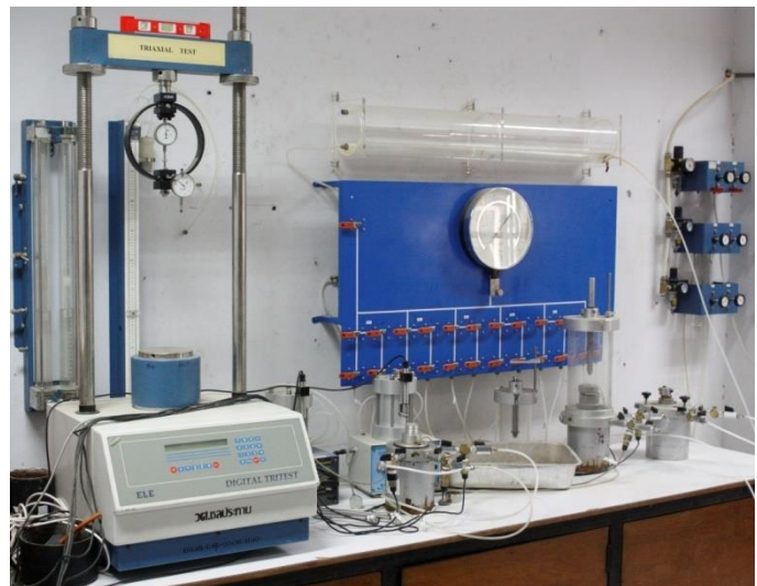
รูปที่ 132 เครื่องทดสอบ confined compression
