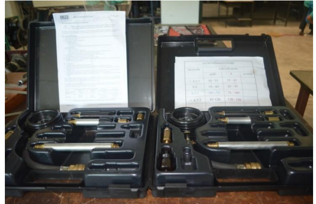
รูปที่ 34 เครื่องมือวัดกำลังอัดเครื่องยนต์
