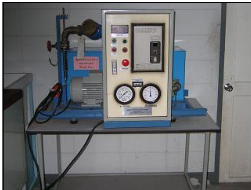
รูปที่ 1.14 ชุดเครื่องมือทดสอบเครื่องสูบน้ำ (Pump) สามารถปรับความเร็วรอบการหมุน และอัตราการไหลได้
