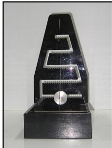
รูปที่ 1.6 ชุดเครื่องมือทดสอบการลอยตัวของวัตถุ (Buoyancy) และเสถียรภาพของวัตถุลอยน้ำ (stability of floating bodies)
