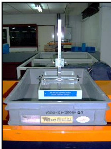
รูปที่ 1.6 ชุดเครื่องมือทดสอบการลอยตัวของวัตถุ (Buoyancy) และเสถียรภาพของวัตถุลอยน้ำ (stability of floating bodies)
