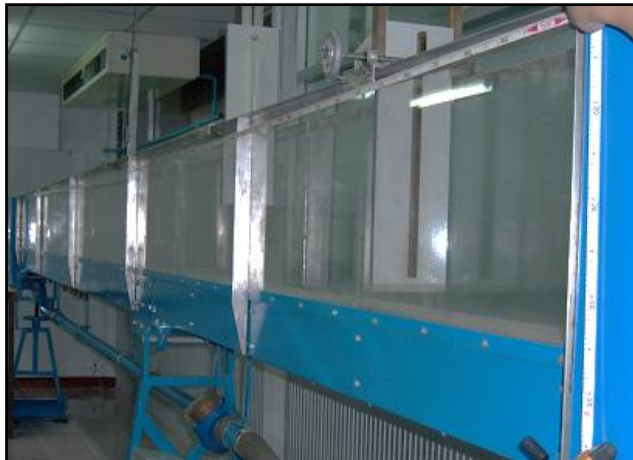
รูปที่ 1.10 ชุดเครื่องมือทดสอบการไหลลอดประตูบานตรง (Flow under the Sluice Gate) และการเกิดน้ำกระโดด (Hydraulic Jump) (รางเปิดมีขนาดกว้าง 15 ซม. และยาว 8.00 ม.)
