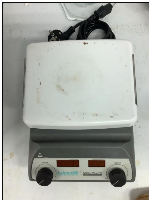
รูปที่ 1.37 เครื่องกวนสารละลายและให้ความร้อน (Hotplate stirrer)
