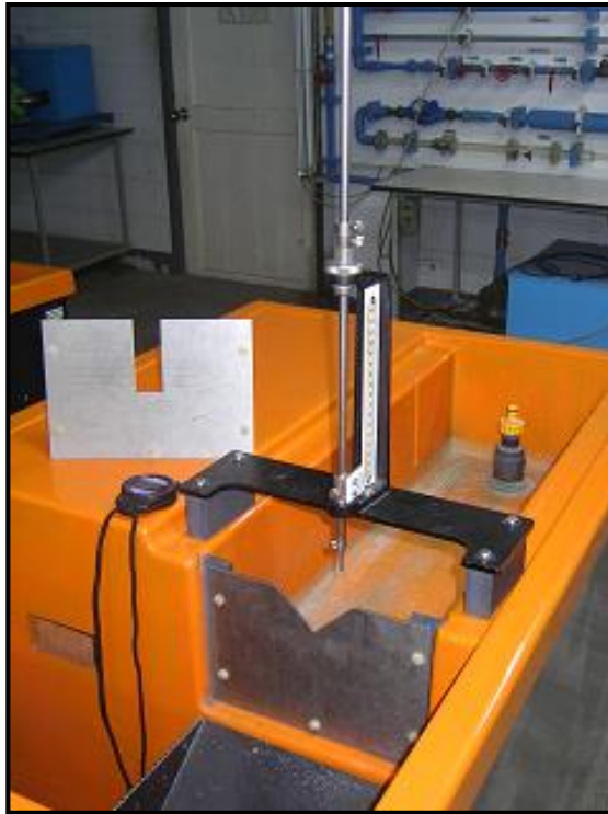
รูปที่ 1.9 ชุดเครื่องมือทดสอบการไหลผ่านฝายน้ำล้น (ฝายสันคมสามเหลี่ยม และสี่เหลี่ยม) (Flow Over Sharp-Crested Weir: "V" Notch Weir and Rectangular Notch Weir)
