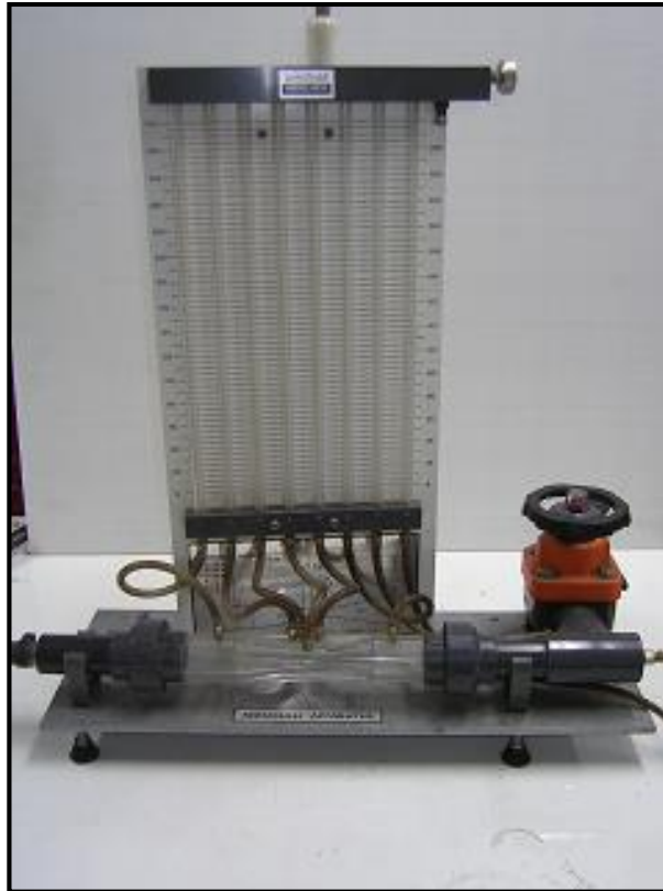
รูปที่ 1.7 ชุดเครื่องมือทดสอบทฤษฎีพลังงาน (Bernoulli's Theorem)
