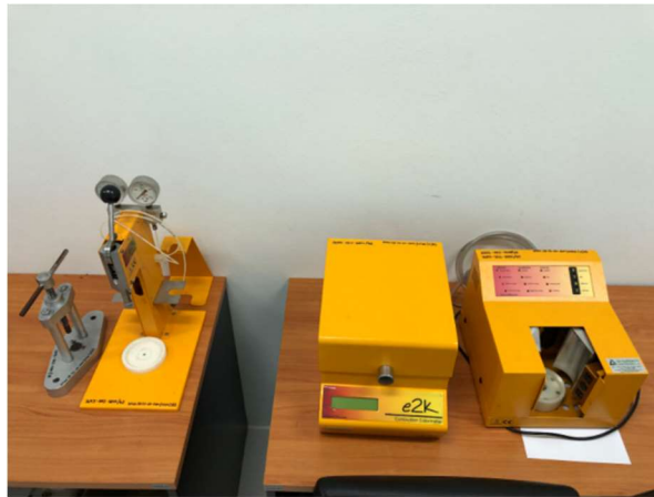
ปฏิบัติการ 20 ทดสอบค่าพลังงานความร้อน Bomb Calorimeter
