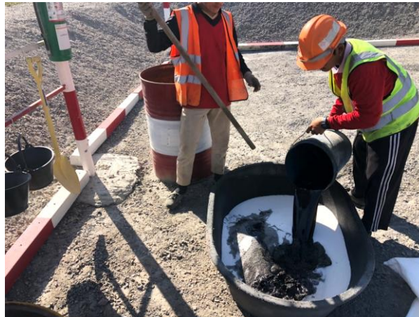
น้ำมันกับปุ๋ยAN ไม่เข้ากัน สังเกต ควันสีเหลือง
