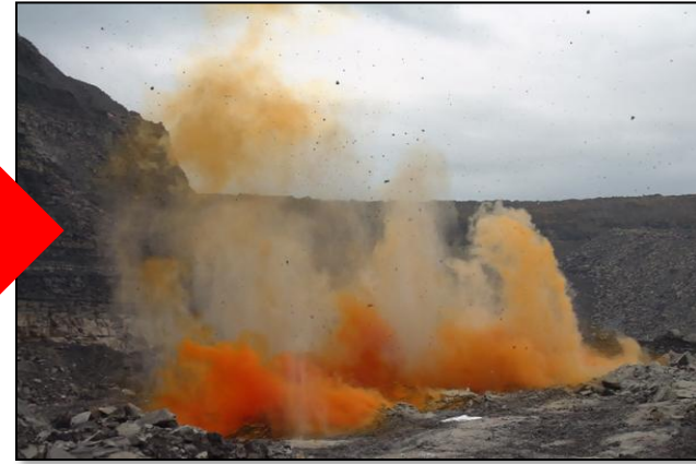
น้ำมันกับปุ๋ยAN ไม่เข้ากัน สังเกต ควันสีเหลือง
