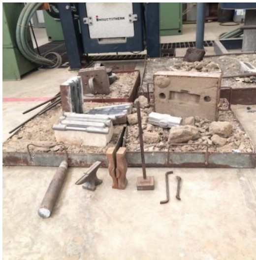
อุปกรณ์และเครื่องมือสำหรับสร้างแบบหล่อทรายขึ้น
