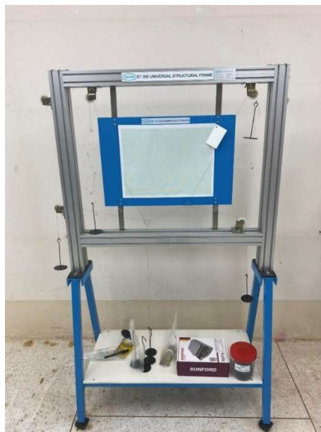
รูปที่ 5.81 ชุดหาความสมดุลของวัตถุแข็งแรงพร้อมการจำลองด้วยซอฟต์แวร์ระบบดิจิทัล
