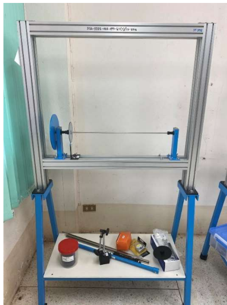
รูปที่ 5.83 ชุดหาแรงบิดในแท่งวัตถุตันและกลวงพร้อมการจำลองด้วยซอฟต์แวร์ระบบดิจิทัล
