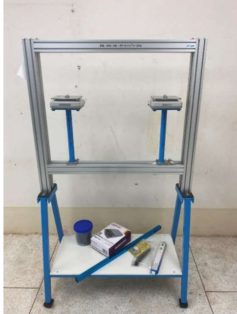
รูปที่ 5.82 ชุดความสมดุลย์ของคานพร้อมการจำลองด้วยซอฟต์แวร์ระบบดิจิทัล
