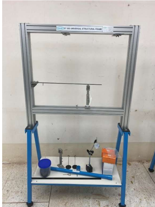
รูปที่ 5.84 ชุดทดลองการแอ่นตัวของคานและปลายยื่นพร้อมการจำลองด้วยซอฟต์แวร์ระบบดิจิทัล
