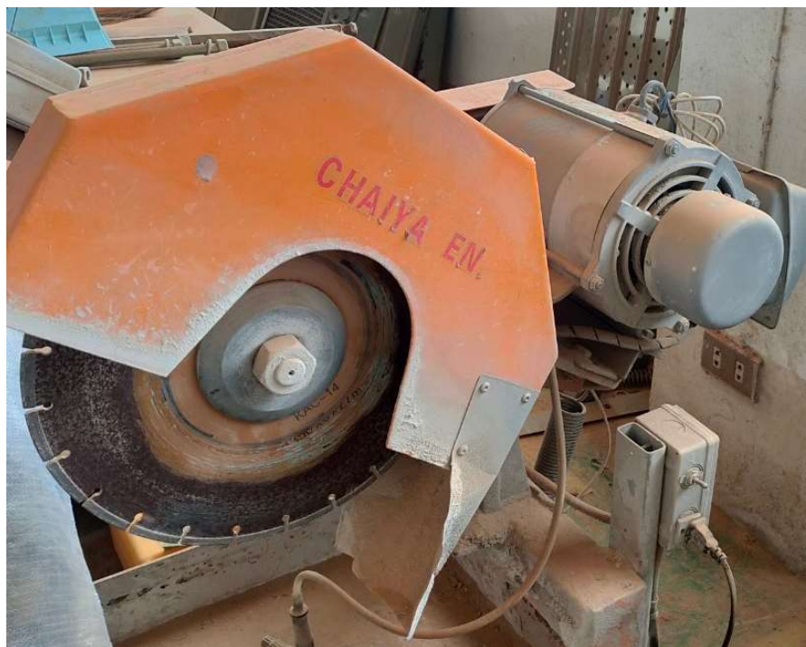
รูปที่ 5.68 เครื่องตัดคอนกรีต (ตำแหน่งการจัดวางตามผังห้องปฏิบัติการตำแหน่งที่ 14)
