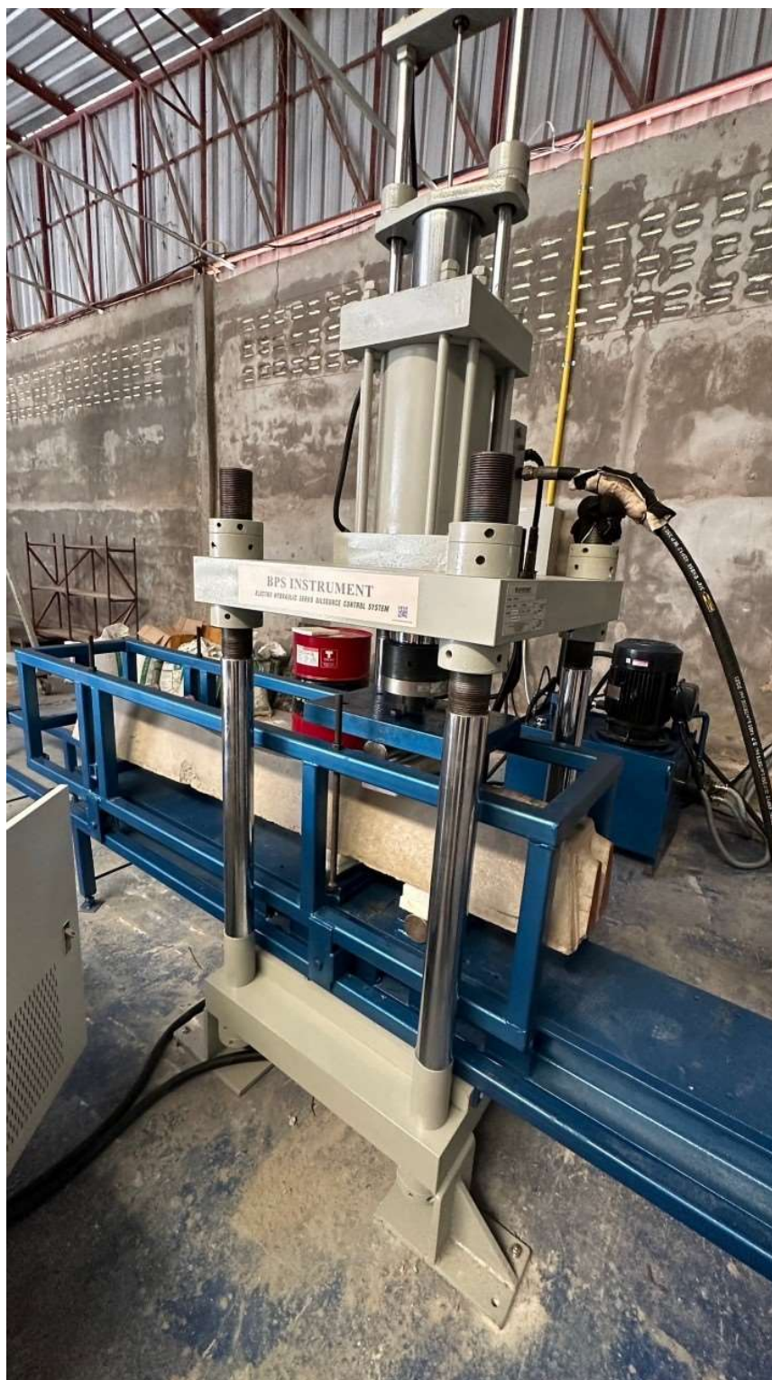
รูปที่ 5.79 เครื่องเหล็กทดสอบเครื่องวัดประมวลผลไดนามิกส์ (Railway Sleeper Testing Machine)
