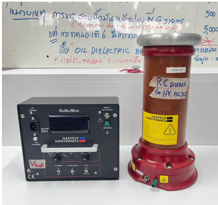
ชุดมิเตอร์วัดไฟฟ้าแรงดันสูงกระแสสลับและกระแสตรง
