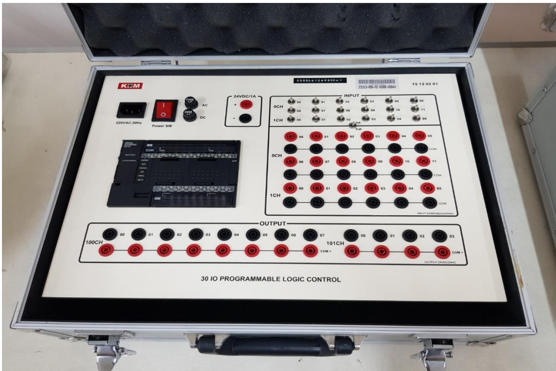
ชุด PLC (Programmable Logic Control)
