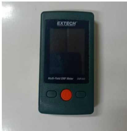
เครื่องวัดความเข้มสนามแม่เหล็กไฟฟ้า (ความถี่ต่ำ)
