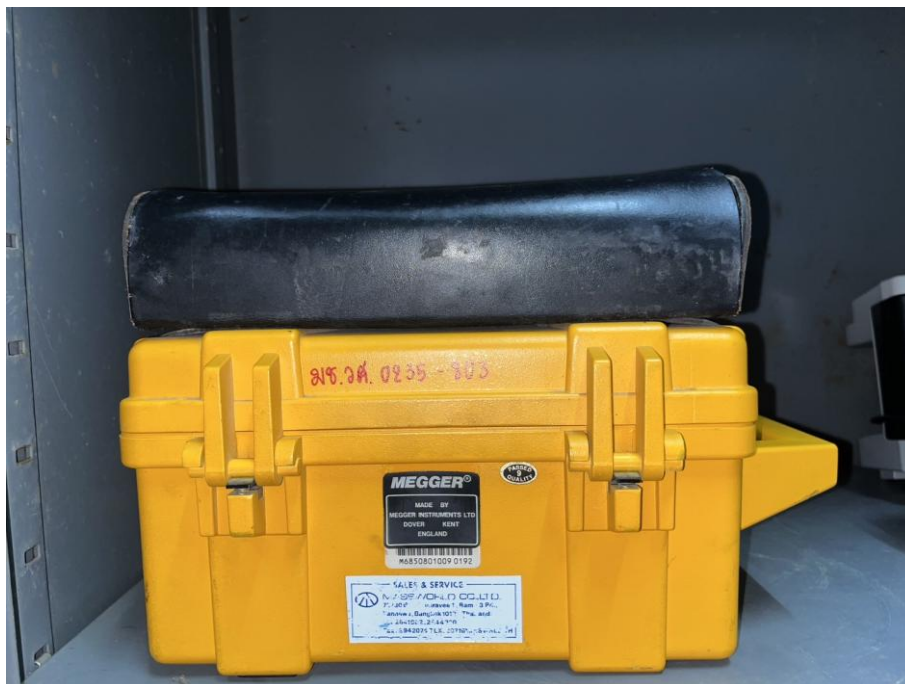
เครื่องวัดความต้านทานแรงสูง MEGGER
