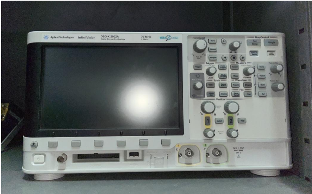
Oscilloscope เครื่องวัดสัญญาณทางไฟฟ้าพร้อมเก็บภาพสัญญาณ
