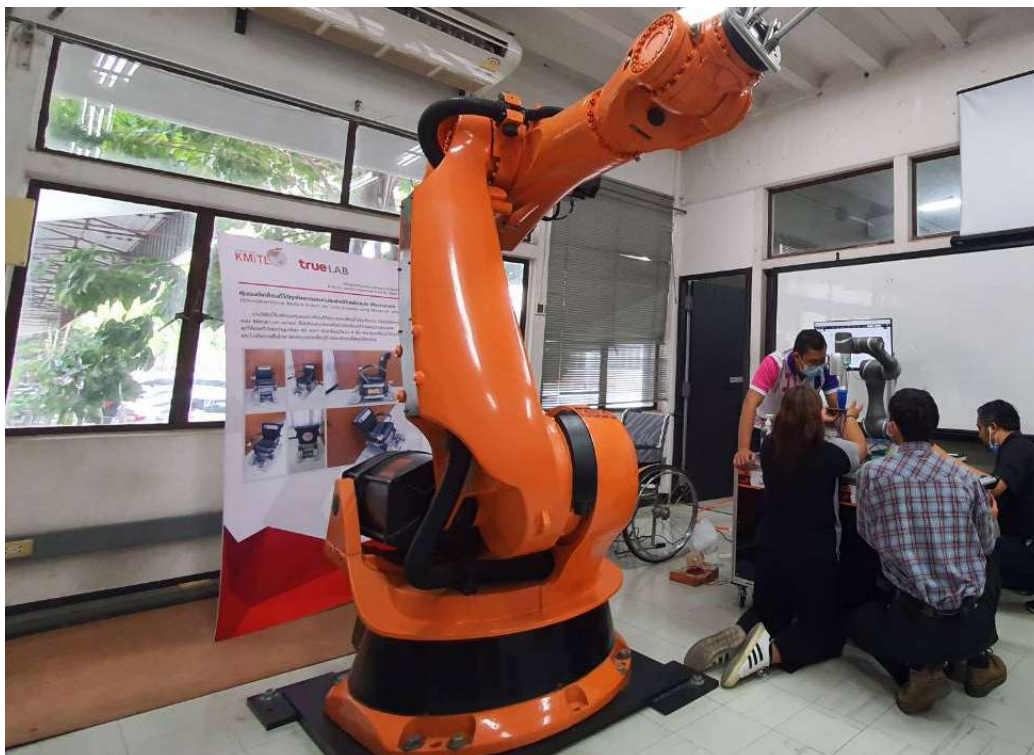
ภาพชุดการทดลองระบบควบคุมหุ่นยนต์อุตสาหกรรม การประมวลผลภาพ และระบบวิทัศน์จักรกล
