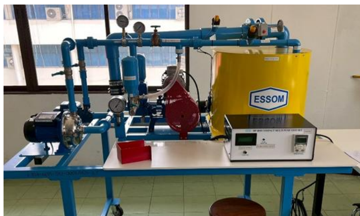
LAB04_02 ชุดปฏิบัติการการทดสอบสมรรถนะของปั๊ม
