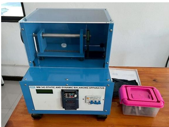
LAB01_01 ชุดปฏิบัติการสมดุลสถิตและไดนามิกส์ หัวข้อการทดลอง 1.1 ปฏิบัติการสมดุลเพลาแบบสถิตและไดนามิกส์
