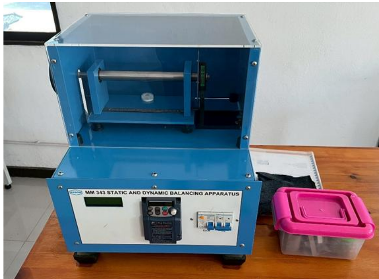
LAB01_01 ชุดปฏิบัติการสมดุลสถิตและไดนามิกส์ หัวข้อการทดลอง 1.1 ปฏิบัติการสมดุลเพลแบบสถิตและไดนามิกส์
