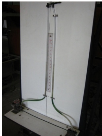
รูปที่ 1 Friction Loss in Pipe
