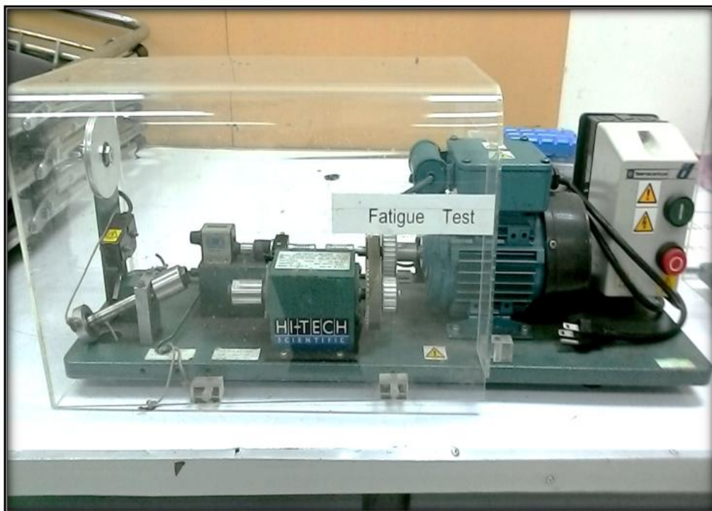
เครื่องมือทดสอบความล้า (Fatigue Testing Machine)
