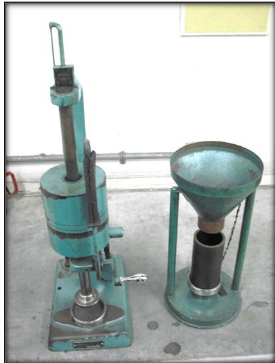
เครื่องมือทดสอบความโปร่งอากาศ (Permeability Tester) และเครื่องอัดขึ้นงาน
