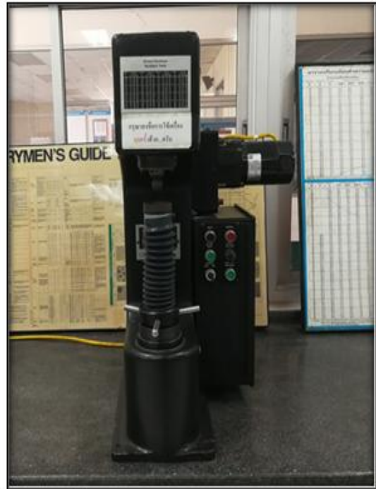
เครื่องทดสอบความแข็งแรงแบบบริเนล
