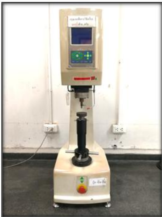
เครื่องทดสอบความแข็งแรงแบบร็อคเวลล์
