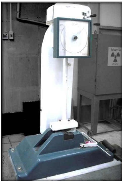
เครื่องมือทดสอบแรงกระแทกพร้อมอุปกรณ์อย่างทำความเย็น (Charpy Impact Testing Machine coupled with Cryogenic bath)
