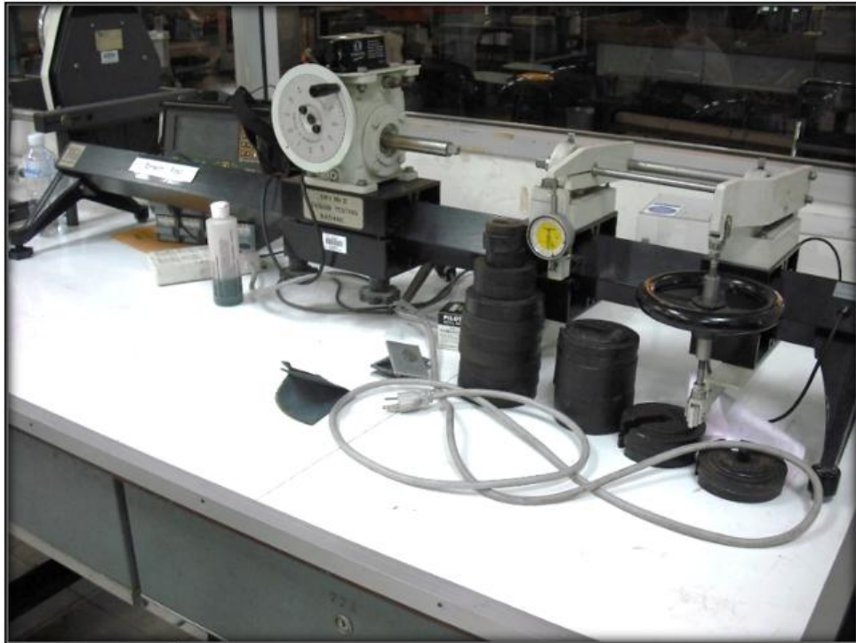
เครื่องมือทดสอบแรงบิด (Torsion Testing Machine)
