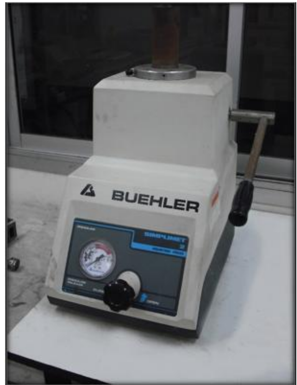
เครื่องขึ้นตัวเรือนชิ้นงาน (Mounting machine)
