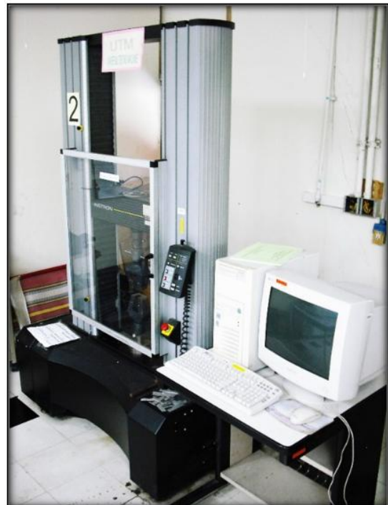
เครื่องมือทดสอบแรงดึงและแรงดัด (Universal testing machine)
