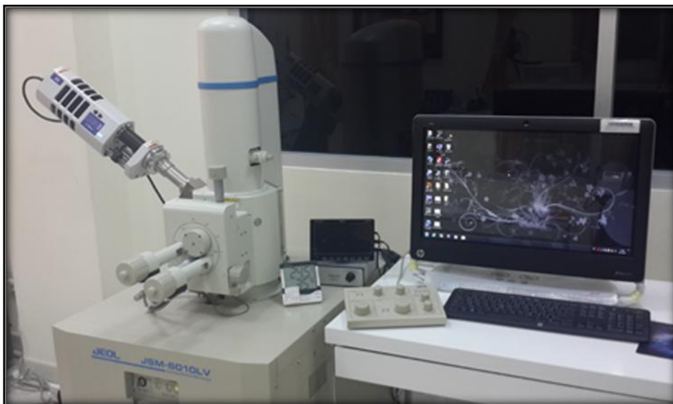
กล้องจุลทรรศน์อิเล็กตรอนแบบส่องกราดพร้อมอุปกรณ์วิเคราะห์ธาตุ EDX (Scanning Electron Microscope coupled with EDX analyzer)
