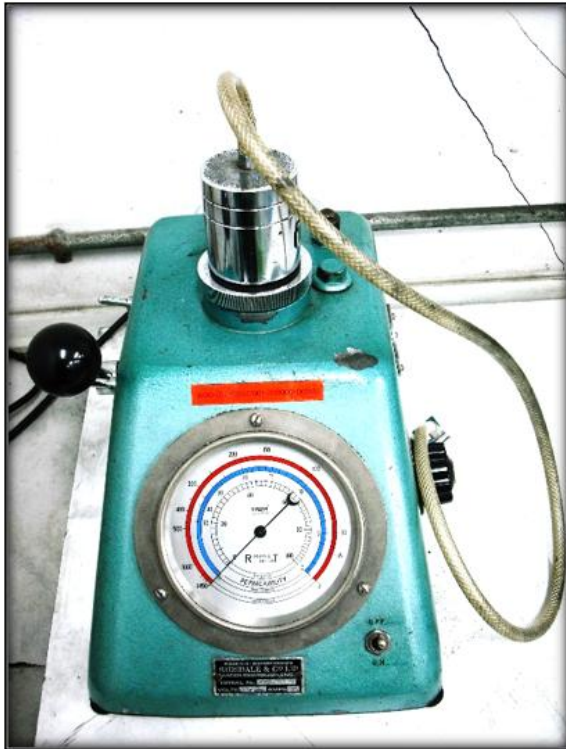
เครื่องมือทดสอบความโปร่งอากาศ (Permeability Tester) และเครื่องอัดขึ้นงาน
