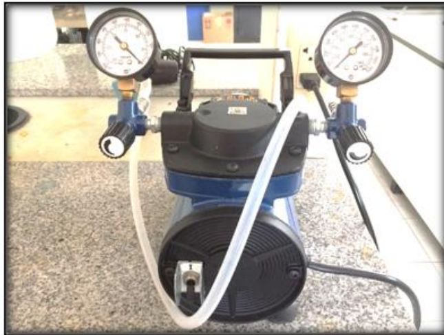
อุปกรณ์หมุนเวียนสารละลาย ป้อนสำหรับดูดช่วยกรองแยก ของแข็งและสารละลาย
