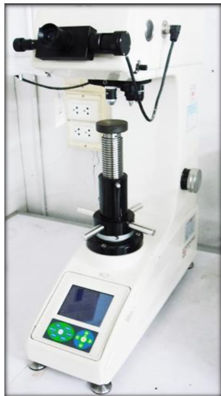
เครื่องทดสอบความแข็งแรงแบบวิกเกอร์ส
