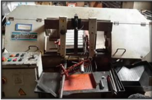
เครื่องตัดชิ้นงานแบบสายพาน
