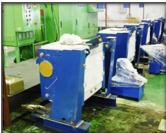
ชุดอุปกรณ์เตาหลอมและชุดควบคุม 1
