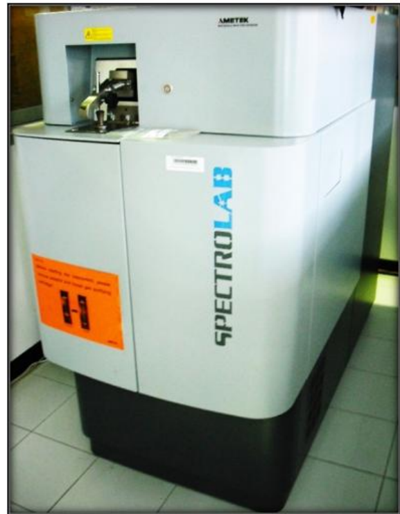
เครื่องมือวิเคราะห์องค์ประกอบทางเคมี (Spectrometer)
