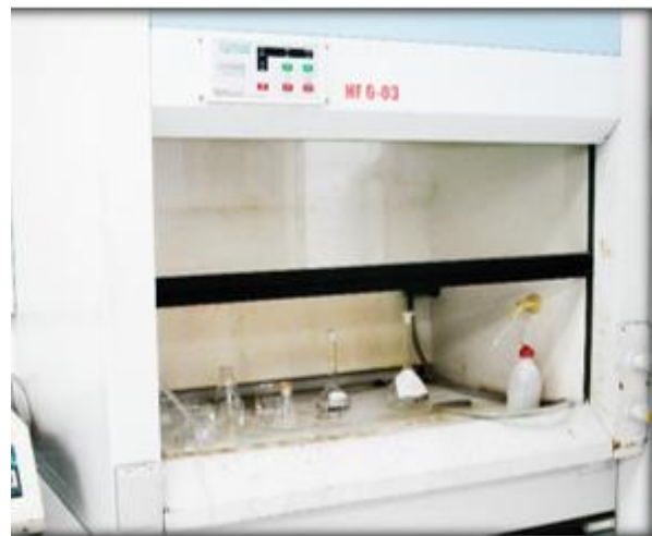
อุปกรณ์กัดผิวชิ้นงานด้วยสารเคมี (Fume cupboard)
