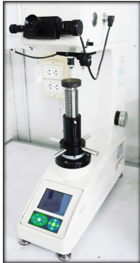
เครื่องทดสอบความแข็งแบบวิกเกอร์ส
