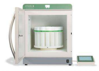
รูปที่ 74 เครื่องย่อยสลายตัวอย่างด้วยระบบไมโครเวฟ (Microwave Digestion System)
