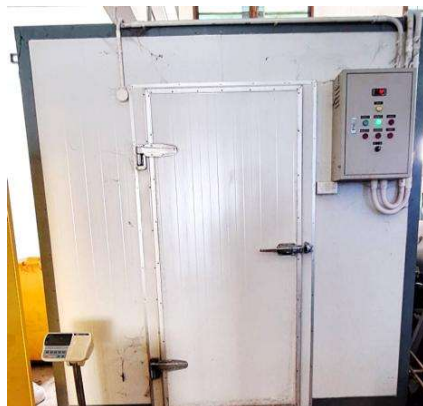
รูปที่ 69 ห้องควบคุมอุณหภูมิต่ำ เพื่อเก็บรักษาคุณภาพของตัวอย่าง
