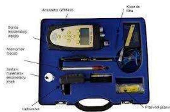
รูปที่ 52 ชุดวิเคราะห์ก๊าซชีวภาพชนิดพกพา
