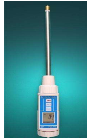
รูปที่ 59 เครื่องวัดความชื้นในกองปุ๋ย
