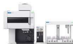
รูปที่ 73 เครื่องวิเคราะห์ปริมาณธาตุด้วยเทคนิค ICP-OES
