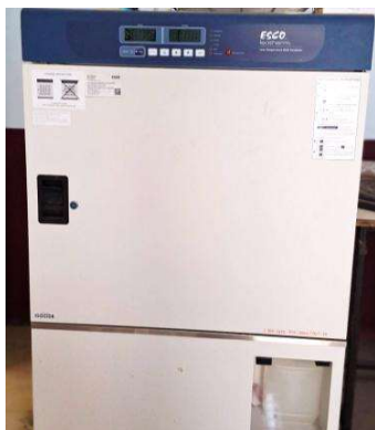
รูปที่ 25 ตู้บ่มบิโอดี (20°C)
