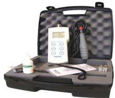
รูปที่ 16 เครื่องวัดค่าออกซิเจนละลายน้ำแบบพกพา
