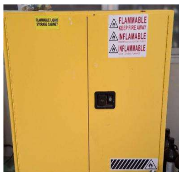
รูปที่ 37 ตู้เก็บสารเคมี
