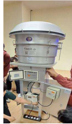
รูปที่ 54 เครื่องเก็บตัวอย่างอากาศ (High Volume Air sampler)
