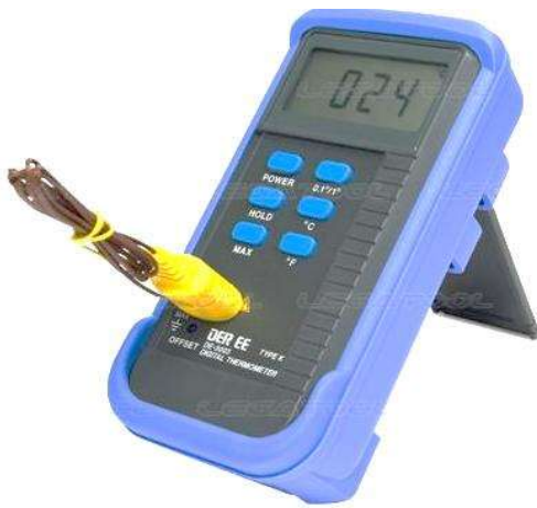
รูปที่ 58 เครื่องวัดอุณหภูมิในกองปุ๋ย
