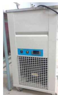
รูปที่ 36 เครื่องหล่อเย็นคอนเดนเซอร์
