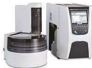
รูปที่ 72 เครื่องวิเคราะห์ปริมาณคาร์บอนอินทรีย์รวม (Total Organic Carbon หรือ TOC)
