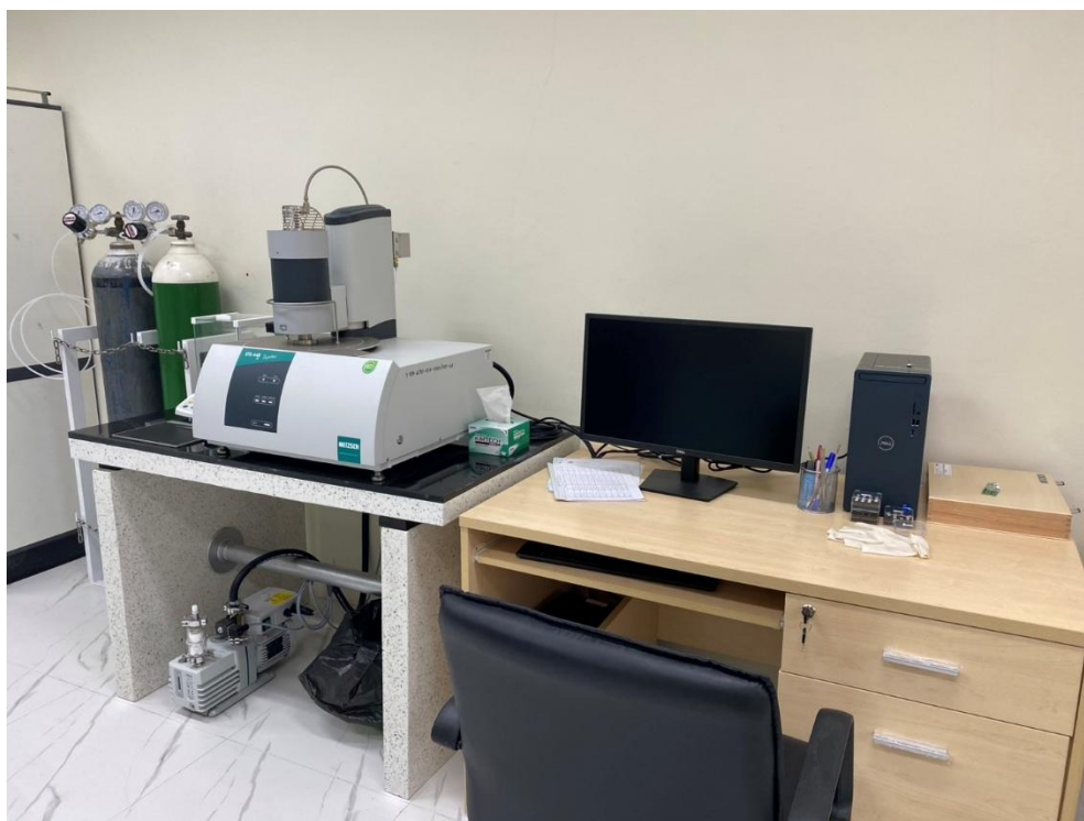
รูปที่ 42 เครื่องวิเคราะห์สมบัติทางร้อนของวัสดุคาร์บอน ยี่ห้อ Netzsch รุ่น STA 449 F5
