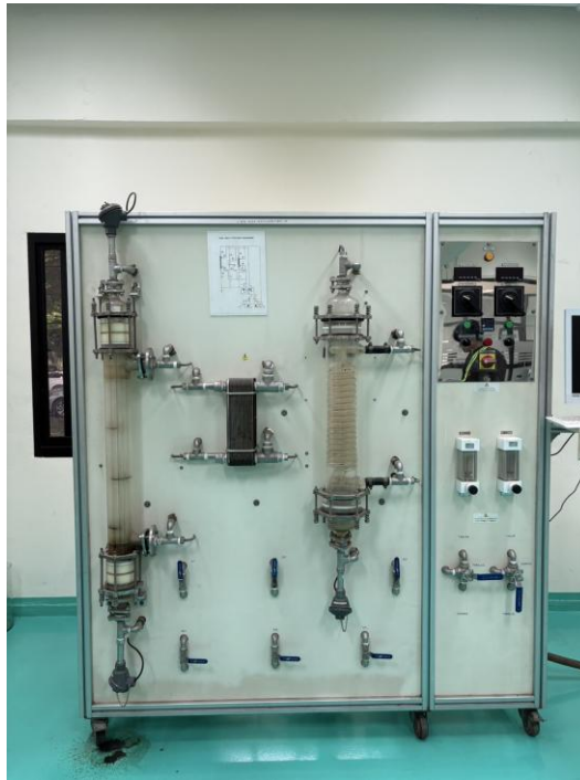
รูปที่ 4 เครื่องแลกเปลี่ยนความร้อนแบบท่อสองชั้น ยี่ห้อ WISDOM INVENTOR รุ่น HTBA
