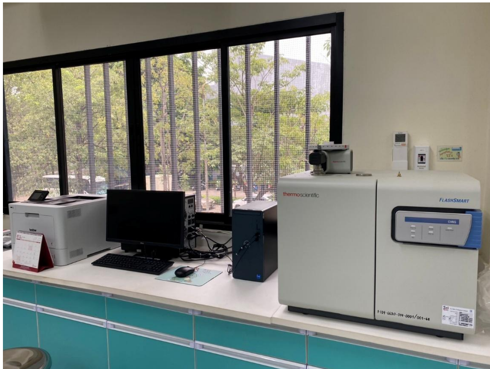
รูปที่ 43 เครื่องวิเคราะห์องค์ประกอบธาตุในวัสดุคาร์บอน ยี่ห้อThermo Fisher Scientific รุ่น FlashSmart
