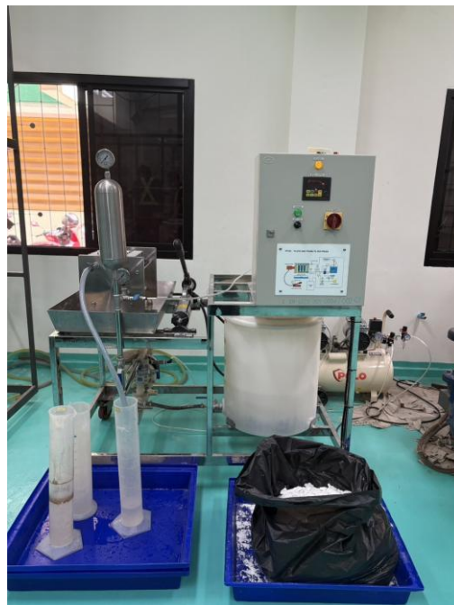
รูปที่ 37 ชุดศึกษาการกรองในเครื่องกรองแบบเพลทเฟรม ยี่ห้อ PSA21 รุ่น PFT200
