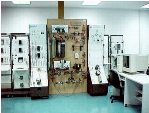
รูปที่ 71 หน่วยทดลองการควบคุมอัตราการไหล
