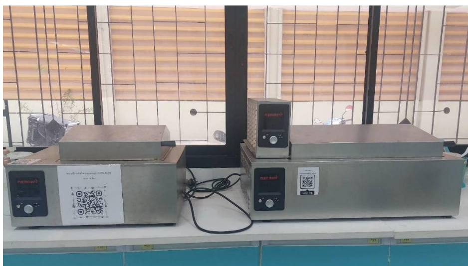
รูปที่ 17 อ่างน้ำควบคุมอุณหภูมิ (WATER BATH) ยี่ห้อ MEMMERT ขนาด 14 ลิตร และ 28 ลิตร
