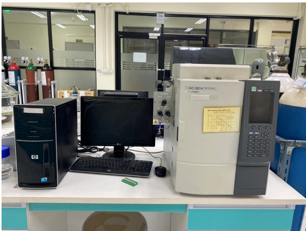
รูปที่ 46 เครื่องวิเคราะห์ห้องประกอบของสาร ยี่ห้อ GC-2014 รุ่น Shimadzu
