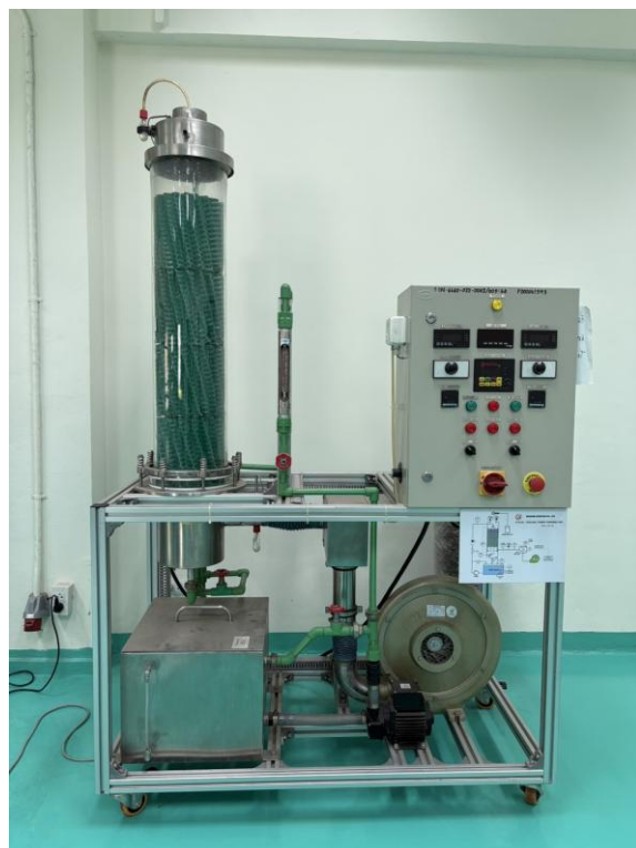
รูปที่ 10 เครื่องทดลองหอยน้ำเย็น ยี่ห้อ WISDOM INVENTOR รุ่น CTD-2G
