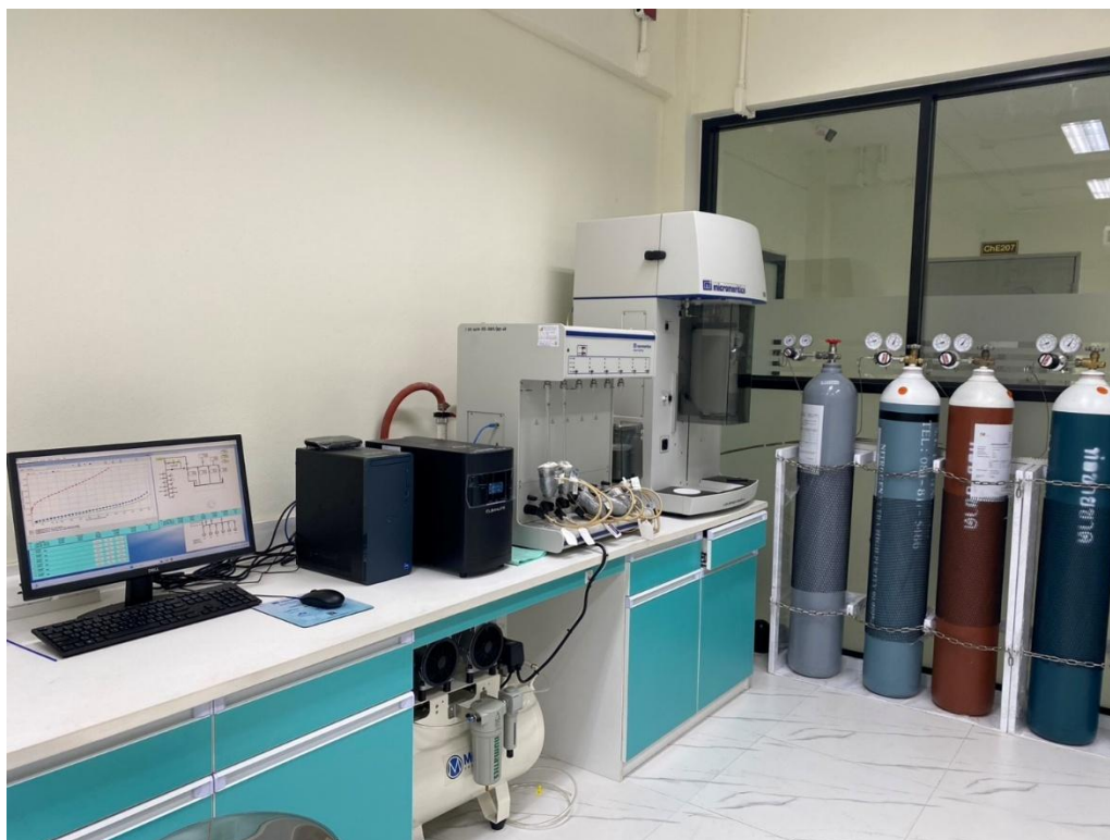
รูปที่ 41 เครื่องวิเคราะห์พื้นที่ผิวและรูพรุน ยี่ห้อ Micromeritics รุ่น 3Flex
