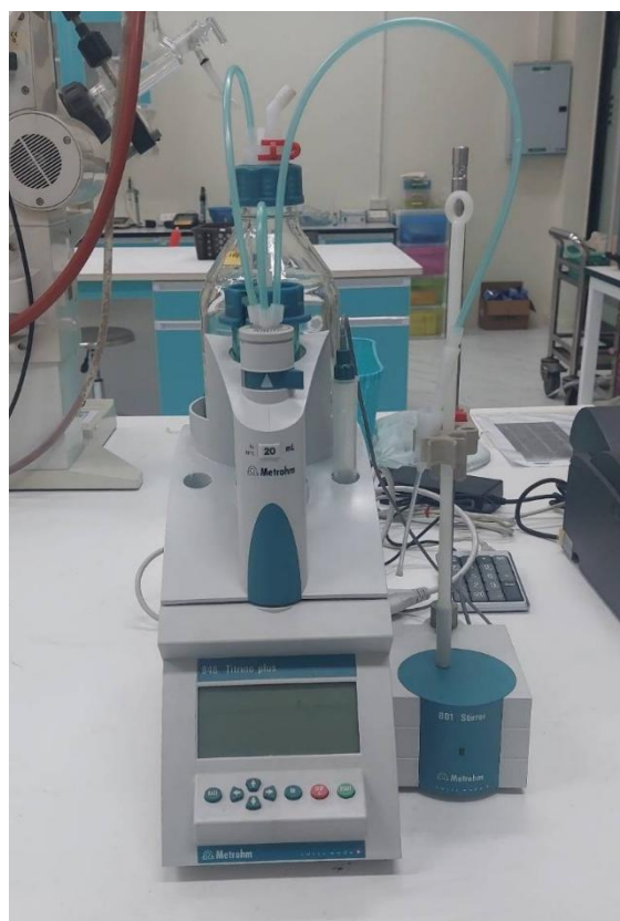
รูปที่ 21 เครื่องไทเทรตอัตโนมัติ ยี่ห้อ Metrohm รุ่น 848 Titrator plus
