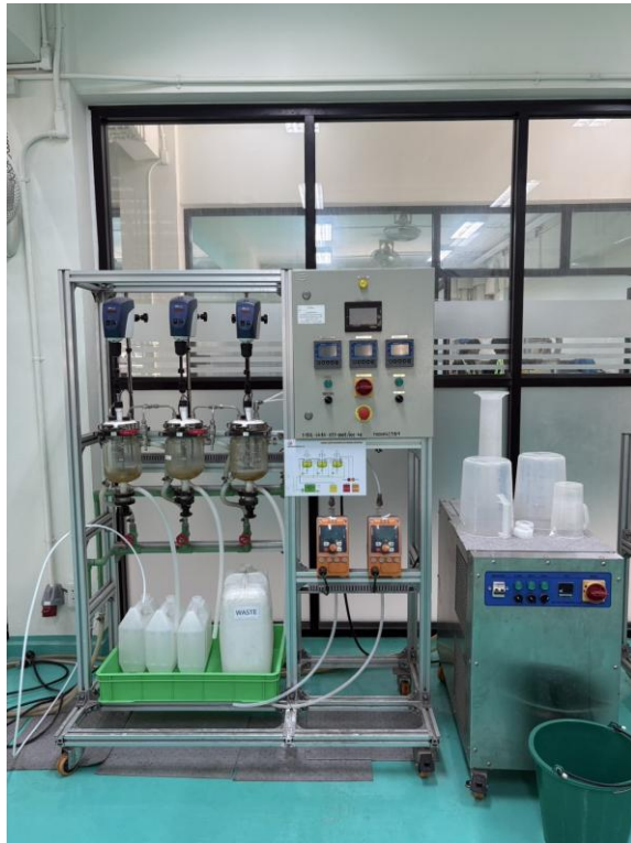
รูปที่ 9 เครื่องปฏิกรณ์เคมีแบบถังกวน ยี่ห้อ WISDOM INVENTOR รุ่น RU02-C
