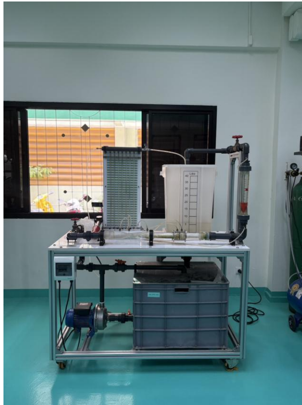
รูปที่ 36 เครื่องวัดอัตราการไหลพร้อมหมุนเวียนและจ่ายน้ำสำหรับการทดลอง รุ่น WF-101
