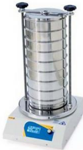
รูปที่ 35 เครื่องคัดแยกขนาด รุ่น WBA-200
