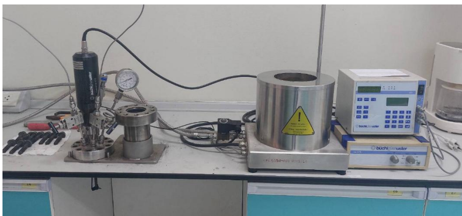
รูปที่ 20 เครื่องปฏิกรณ์แบบถังกวน ยี่ห้อ Buchi Glasuster
