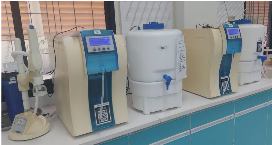
รูปที่ 22 เครื่องทำน้ำบริสุทธิ์คุณภาพสูง รุ่น SMART-ROP15, AMART-PUV
