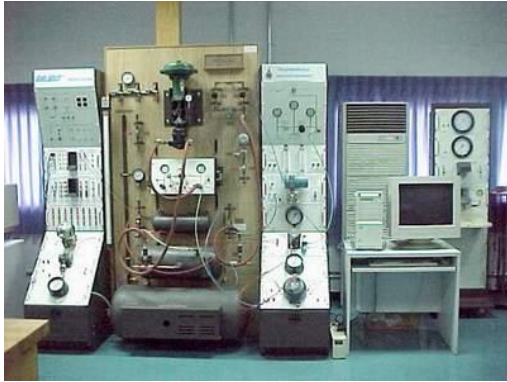
รูปที่ 69 หน่วยทดลองการควบคุมความดัน
