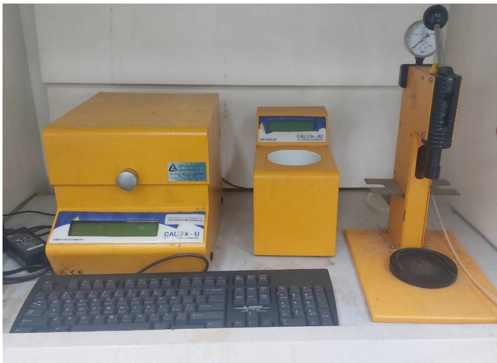
รูปที่ 15 เครื่องทดสอบหาค่าความร้อนของเชื้อเพลิง ยี่ห้อ DDS รุ่น 3K-1
