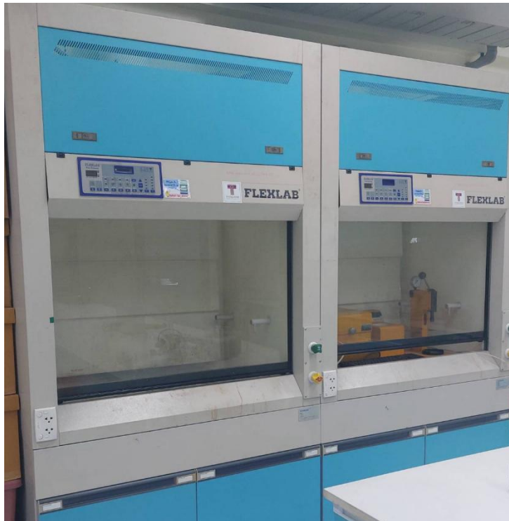
รูปที่ 18 ตู้ดูดไอสารเคมี ยี่ห้อ Flexlab รุ่น FH 1.20 DC
