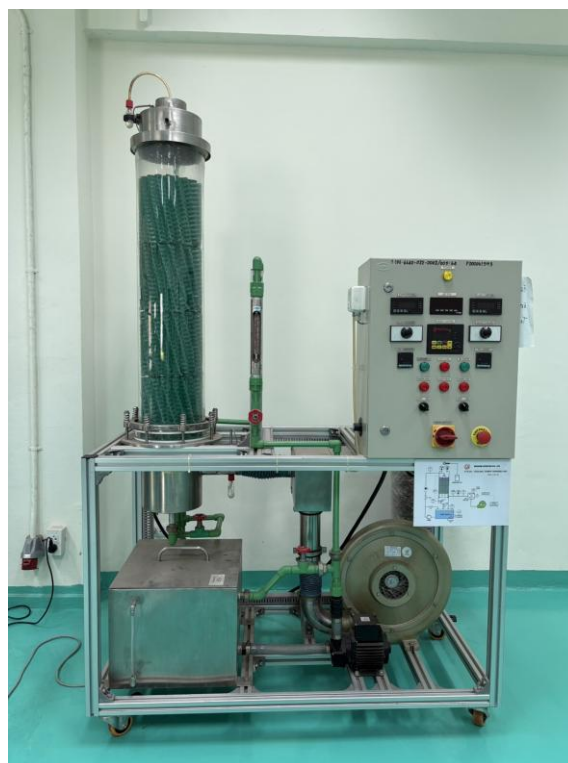
รูปที่ 3 หอหล่อเย็น (COOLING TOWER) ยี่ห้อ QVF รุ่น CT 1
