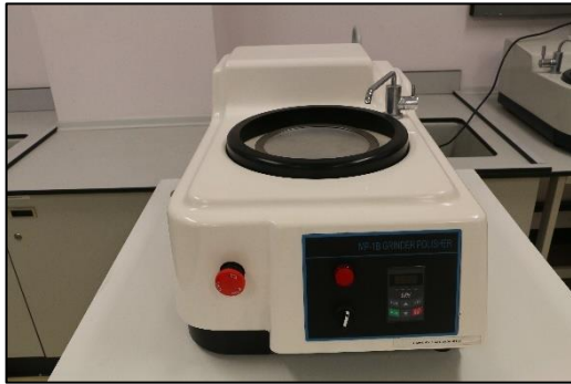
รูปที่ 30 เครื่องตัดผิวโลหะแบบจานเดี่ยว
