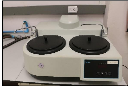
รูปที่ 31 เครื่องตัดผิวโลหะแบบจานคู่
