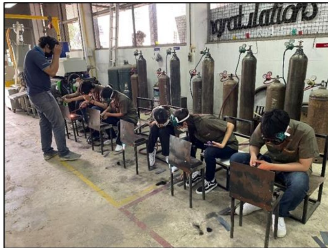
รูปที่ 10 ชุดเชื่อมแก๊สอะเซติลีนและชุดแก๊สสำหรับตัดเหล็ก
