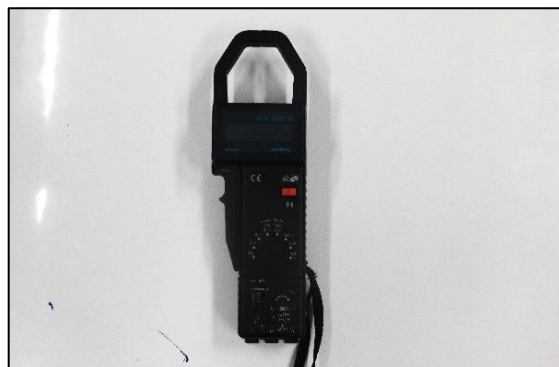
รูปที่ 96 แคลมป์มิเตอร์ (วัดกำลังไฟฟ้าได้)
